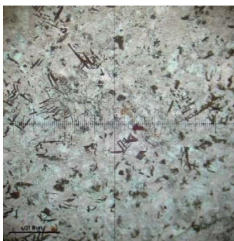
تصویر (۵-۱۷) تصاویر مقطع نازک So-P-1-L در دو حالت XPL (سمت راست) و PPL (سمت چپ). بلورهای سوزنی اکسیدهای تیتانیوم و آهن در متنی از کانی‌های ثانویه درهم بخوبی دیده می‌شود.
