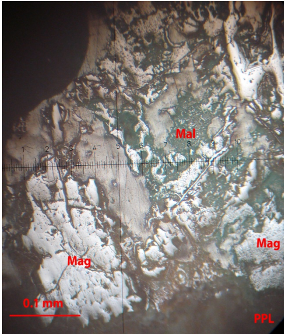
تصویر ۱۲: ترکیبی از مالاکیت (Mal)، مگنتیت (Mag)، هماتیت و گوتیت در بخش‌هایی که بشدت تخریب شده بود
