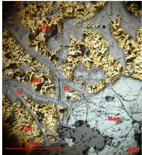
تصویر ۱۱: کالکوپیریت (Cha) همراه با واکنش‌های حاشیه‌ای که تبدیل به دیژنیت (Di) در آن دیده می‌شود.
