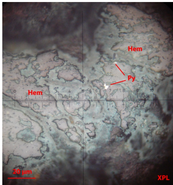
تصویر ۱۰ ذرات پیریت (Py) در داخل هماتیت (Hem) در نمونهی So-S-1-P
