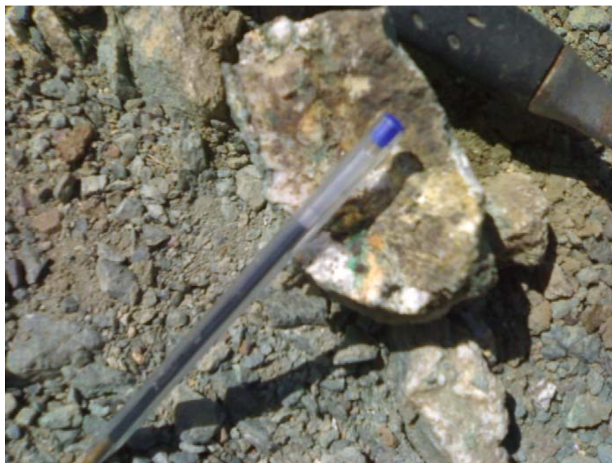
تصویر ۵-۱۳: کانه‌زایی در داخل سیستم سیلیسی در داخل امتداد اصلی
