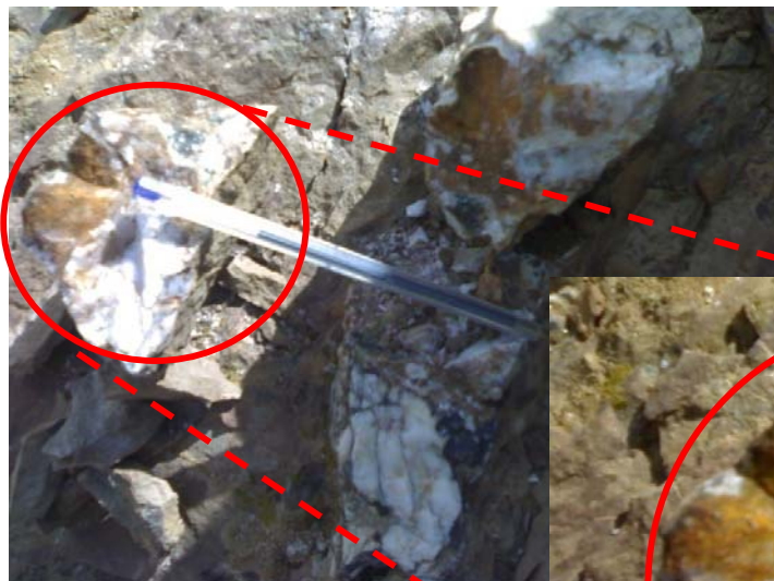
تصویر ۸۵-۵: کانی‌زایی بصورت سولفیدهای مس در داخل سیلیس‌های جنوب‌روستای‌الگزیب.
