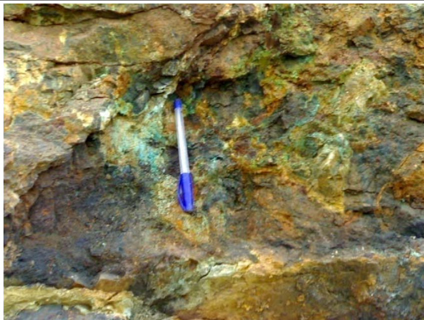
تصویر ۳۴-۵: نمایی از متاسوماتیزم شدید در سنگ‌های معدن ارجین همراه با کانی‌زایی مس
