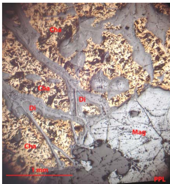
تصویر ۵-۶۰: کالکوپیریت (Cha) همراه با واکنش‌های حاشیه‌ای که تبدیل به دیژنیت (Di) در آن دیده می‌شود.
