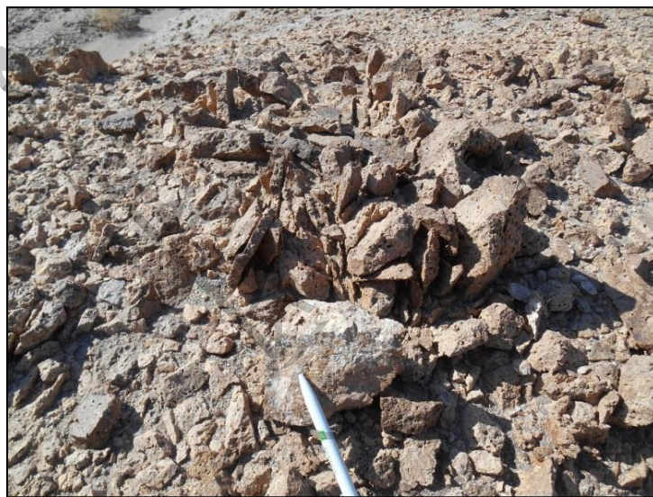
شکل ۵-۱۶ - واحدهای ولکانیکی در محل تزریق توده نفوذی به شدت سیلیسی و حاوی اکسیدهای آهن
