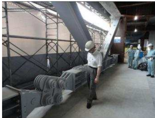
شکل ب-۵ میراگر اصطکاکی ۴ مفصله با ظرفیت ۲۲۵۰ کیلونیوتن
