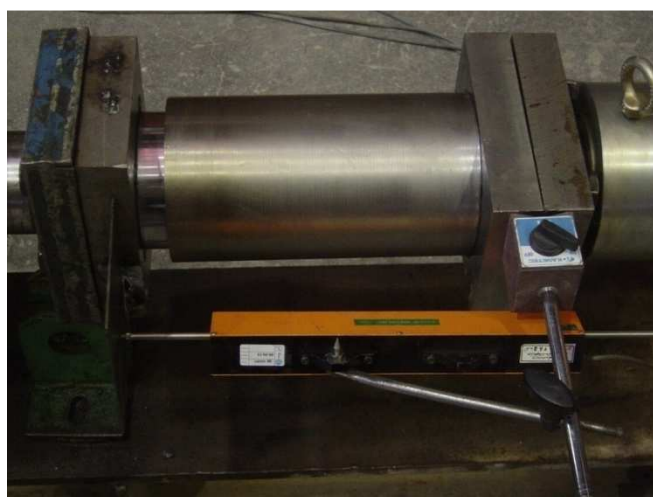
شکل الف-۶۲- نحوه اتصال خط کش الکترونیکی به دو سر میراگر
