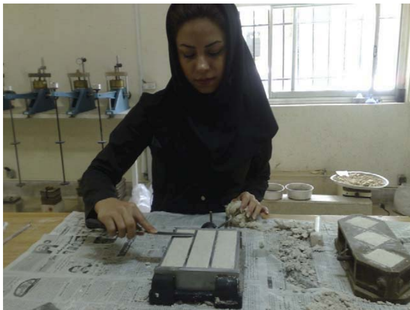
تصویر ۲۶-۳ قالب های گچ جهت آزمون های مقاومت فشاری و خمشی
