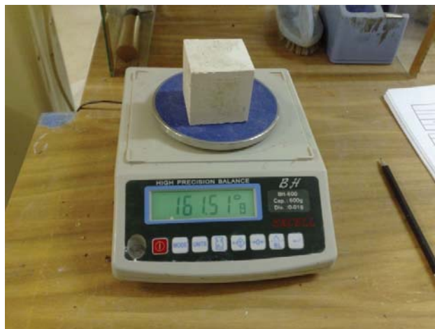
تصویر ۳-۳۳ ترازوی اندازه گیری وزن مکعب های گچی جهت آزمون دانسیته
