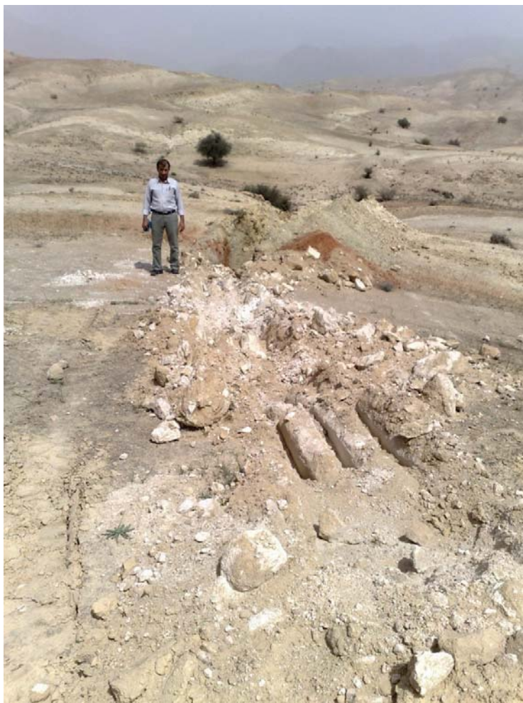
تصویر ۳-۵ ترانشه شماره ۵ دارای ۱۱۳ متر طول واقع در بخش جنوبی منطقه این ترانشه تعداد ۵ لایه گچی را قطع کرده و بالا ترین ضخامت لایه گچی در این ترانشه ۲۵/۸۰ متر بوده است.
