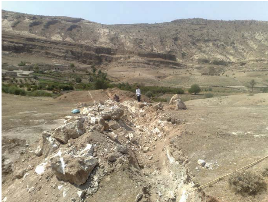
تصویر ۲-۳ ترانسه شماره ۲ دارای ۱۳۹ متر طول واقع در بخش جنوبی منطقه این ترانسه تعداد ۷ لایه گچی را قطع کرده و بالا ترین ضخامت لایه گچی در این ترانسه ۲۳ متر بوده است.
