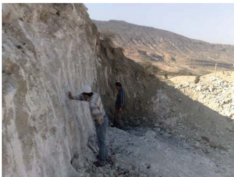
تصویر ۳-۱۵ سینه کار بازگشایی شده در طی اجرای طرح به ابعاد 4 \times 5 \times 10
