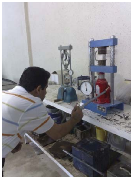
تصویر ۲۷-۳ دستگاه Point Load اصلاح شده برای آزمون مقاومت فشاری
