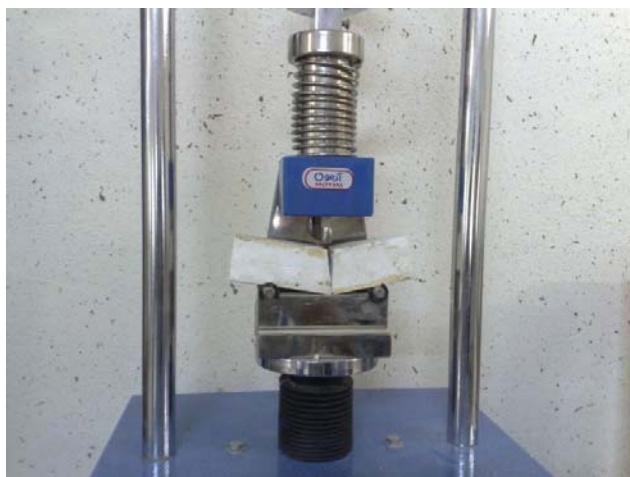
تصویر ۳-۳۱ نقطه حداکثر تاب خمشی و شکستن بلوک گچی
