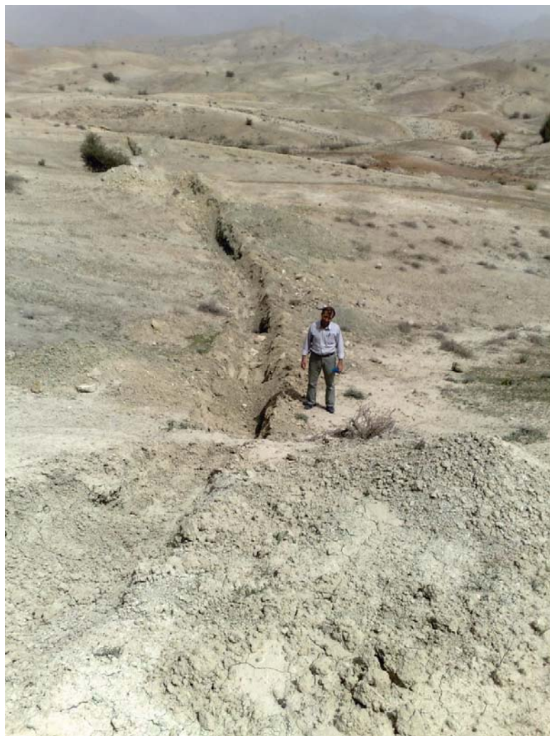
تصویر ۳-۴ ترانشه شماره ۴ دارای ۷۲ متر طول واقع در بخش جنوبی منطقه این ترانشه تعداد ۵ لایه گچی را قطع کرده و بالا ترین ضخامت لایه گچی در این ترانشه ۱۰/۳۰ بوده است.
