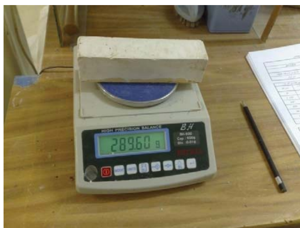
تصویر ۳-۳۴ ترازوی اندازه گیری وزن مکعب های گچی جهت آزمون دانسیته
