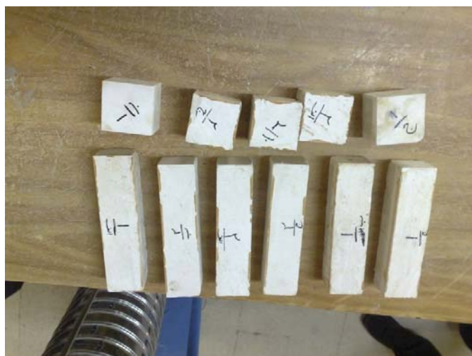
تصویر ۲۹-۳ بلوک‌های مستطیلی تهیه شده برای آزمون مقاومت خمشی
