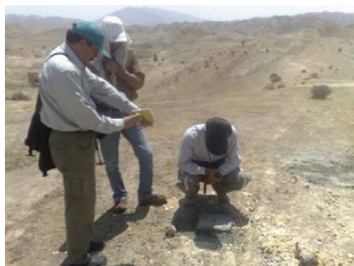
تصویر ۱-۳ یکی از ایستگاه های نقشه برداری که بتون و میخ کوبی شده است
