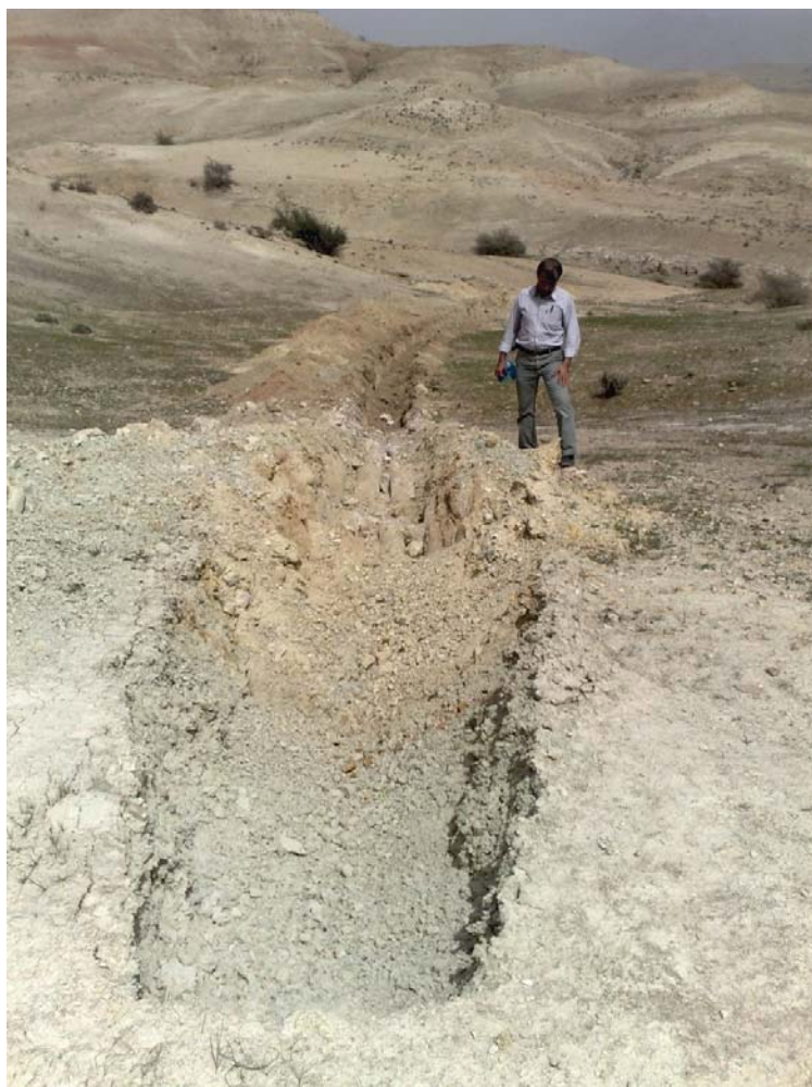
تصویر ۳-۶ ترانسه شماره ۶ دارای ۶۸ متر طول واقع در بخش جنوبی منطقه این ترانسه تعداد ۱ لایه گچی را قطع کرده و بالا ترین ضخامت لایه گچی در این ترانسه ۱۰/۷۰ متر بوده است.
