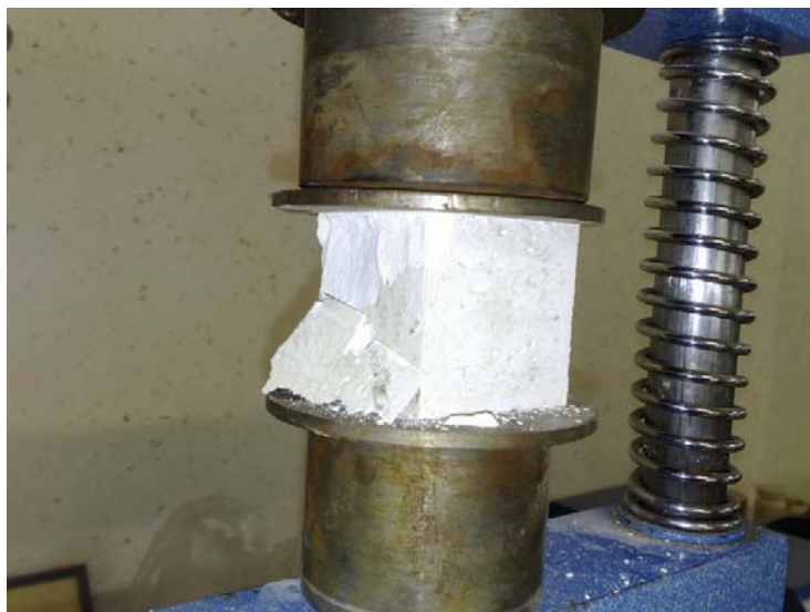
تصویر ۲۸-۳ نقطه نهایی مقاوت فشاری و خورد شدن بلوک گچ
