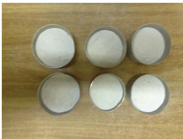
تصویر ۱۹-۳ ظروف اندازه گیری درصد رطوبت که گچ در داخل آنها توزین می شود.
