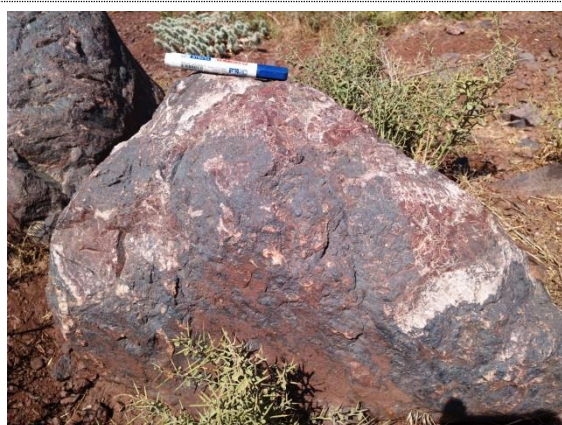
شکل ۶- کانی‌سازی آهن مگنتیتی به همراه باریت در نوار کانی‌سازی جوشالو در جنوب محدوده
