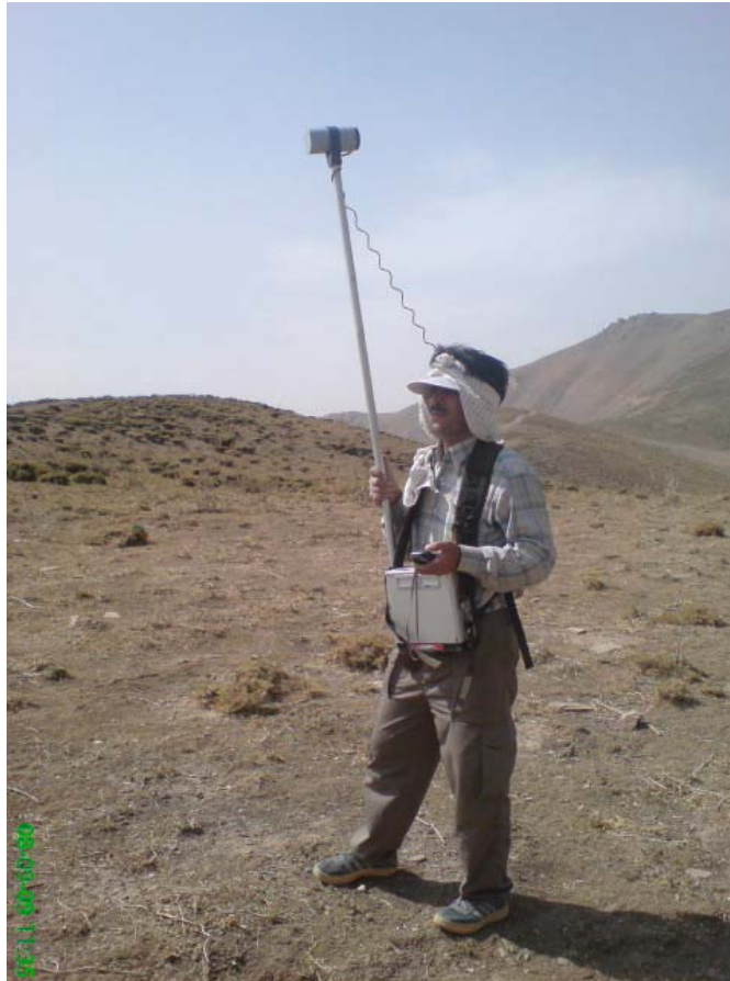
تصویر شماره ۷ - عملیات اندازه گیری مغناطیس با استفاده از مغناطیس سنج MP3
