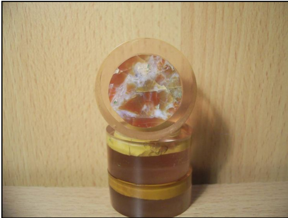
تصویر ۹۵: مقطع تهیه شده از آگات قرمز رنگ محدوده کلوت جهت تعیین سختی
