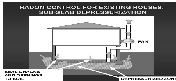
شکل 3: نحوه ی عایق بندی و تهویه مناسب برای منازل جهت خروج رادون
