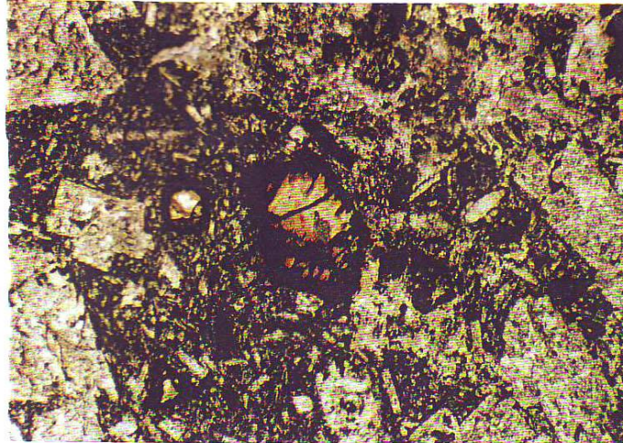
شماره 79.T.48 عکس شماره 31- نمودی از یک درشت بلور اولیوین که سرپانتینی و ایدنگسیتی شده و در زمینه اینترسرتال بازالت قرار گرفته است. (نور پلاریزه خطی) NL (10×6.3).
