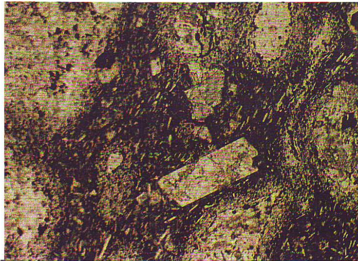
شماره 79.T.39 عکس شماره 17- نمونه ای از سنگ بیگانه ریوداسیتی بهنوان فنوکلاست در زمینه سنگ NL (x6.3 × 10).
