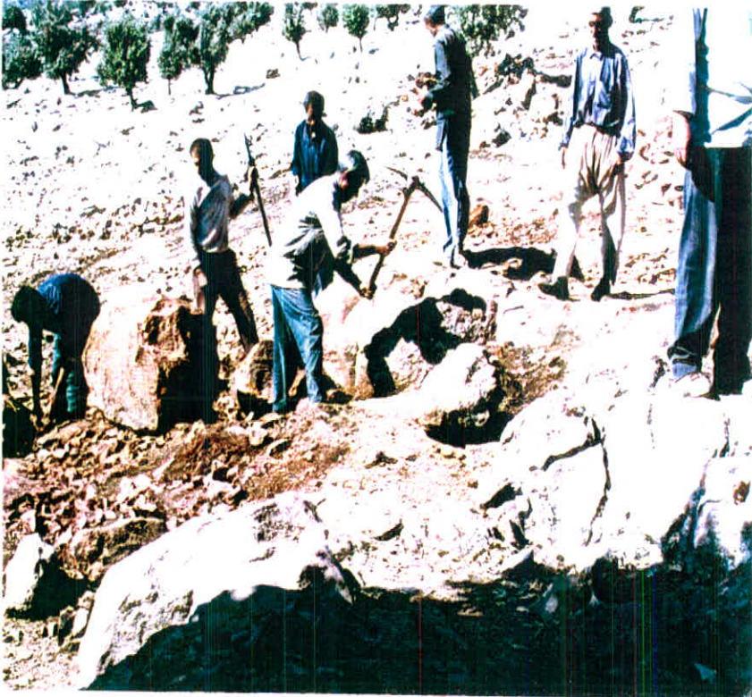
عکس ۱- عدسیهای بوکسیتی بدون پوشش سنگی (Overburden) با شیب ملایم کمتر از ۱۰ درجه در ناحیه مندون.
