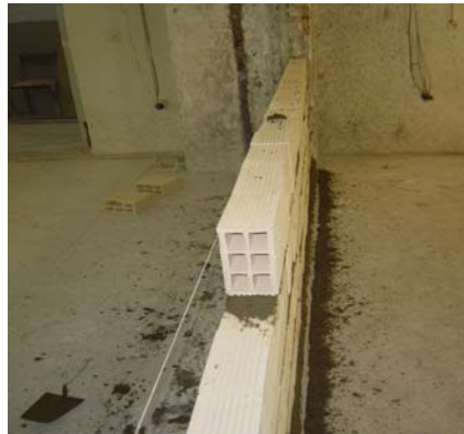
شکل ۴-۱-۲-۱- نمونه‌هایی از بلوک سفالی و دیوار ساخته شده با آنها در آزمایشگاه
