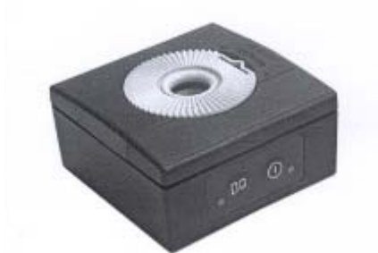
شکل ۳-۲-۷-۱- کالیبراتور تراز صدا مدل ۴۲۳۱
