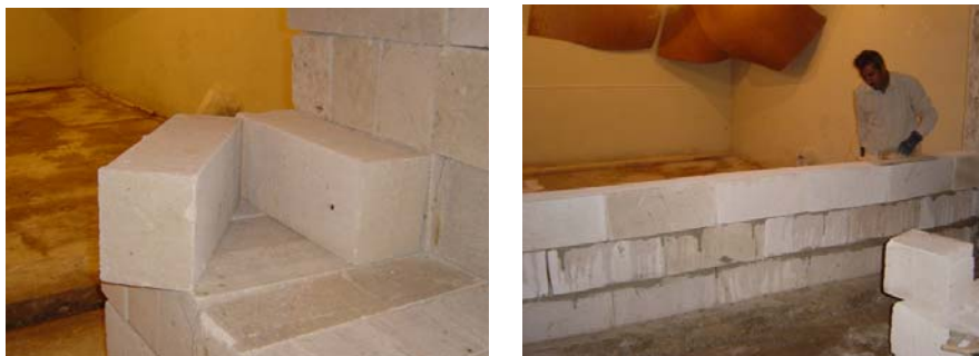
شکل ۴-۲-۱: نمونه‌ای از بلوک بتن سبک و دیوار ساخته شده با آن در آزمایشگاه
