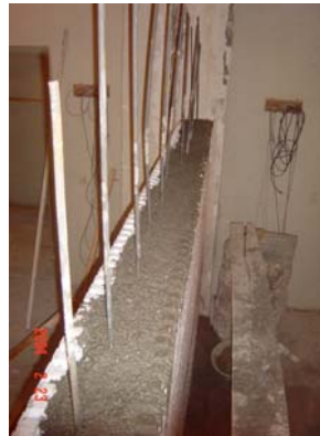
شکل ۴-۵-۳- ساخت دیوار با سیستم ICF با بلوک‌های پلی استایرن انبساطی در آزمایشگاه
