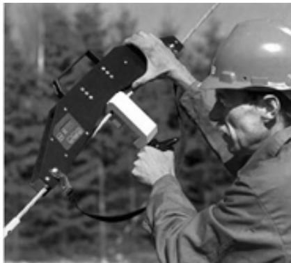
شکل (۲-۵) دستگاه اندازه‌گیری میزان تنش کابل‌ها
