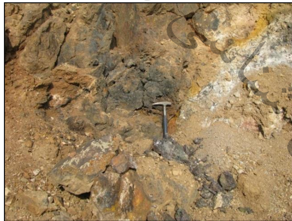
شکل ۵-۱۲- نمایی از زون دگرسانی هماتیته حاوی کانی سازی فلورین در محل معدن حبیبیان
