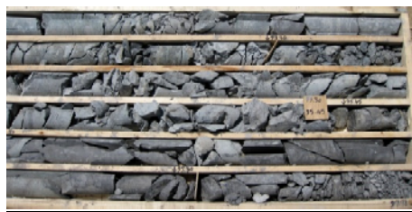
شکل ۱۴: نمایی از مغزه های اخذ شده از سنگ میزبان آندزیتی در گمانه SAR-01
