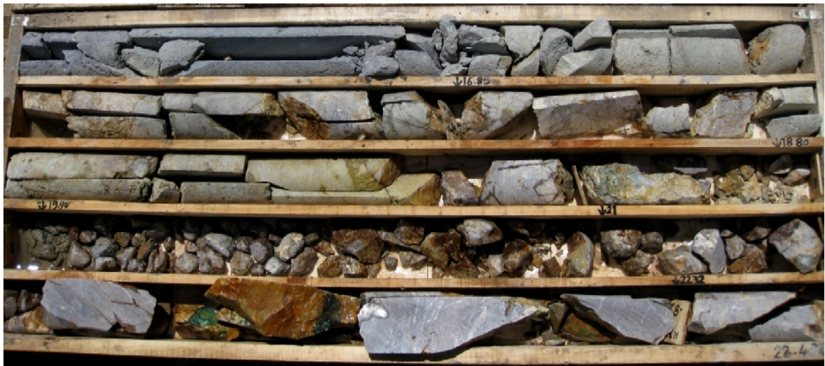
شکل ۱۳- نمایی از رگه کوارتزی و سنگ میزبان آندزیتی DEPTH 15.34-22.49. BOX4.SAR-01
