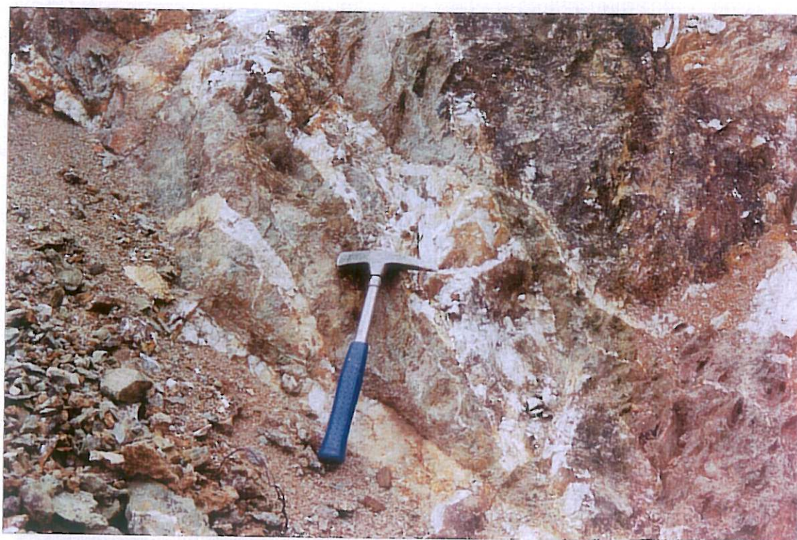
عکس ۱۳- زون دگرسانی کلریتی به رنگ سبز و شاخه هایی از رگه باریت در سنگ میزبان ، معدن گوگ تپه
