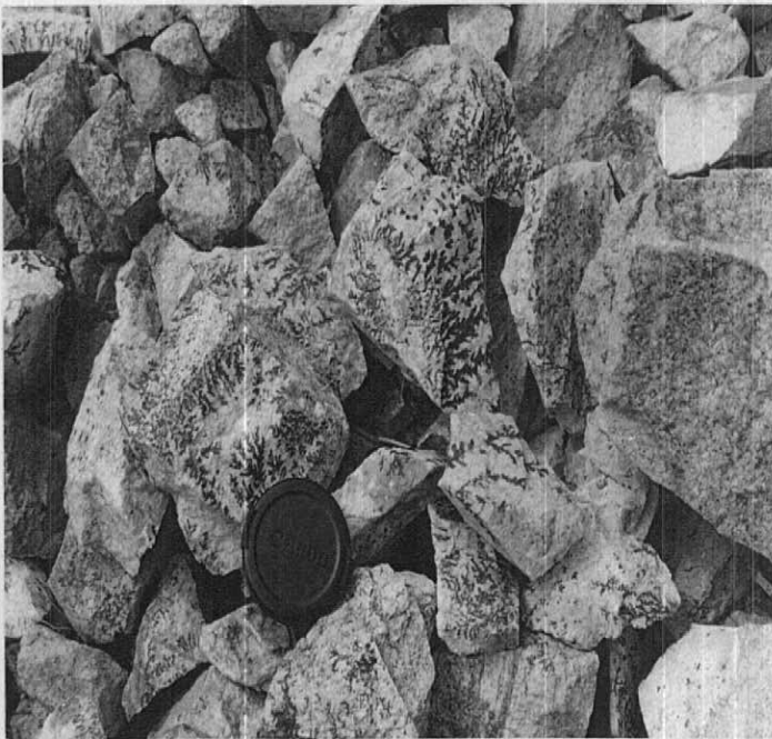
تصویر شماره ۴۴: دندریتهای منگنز را در سنگ‌های دگرسان شده سیلیسی، سریسیتی و هماتیتی نشان می‌دهد.
