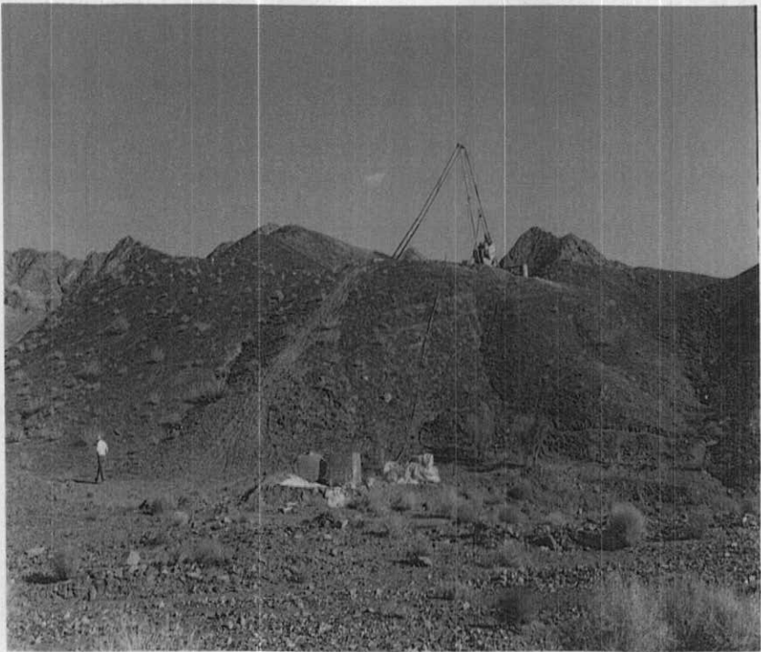
تصویر شماره ۵۲: دستگاه حفاری بر روی تپه مستقر گردیده و به سوی رگه شماره ۱۱۷K1 حفاری می‌نماید.
