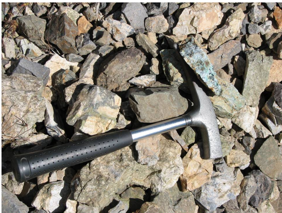
شکل (۱-۶): قطعه سنگ سیلیسی کف آبراهه، حاوی کانه فلزی گالن، کالکوپیریت و ملاکیت (نمونه 58m1)
