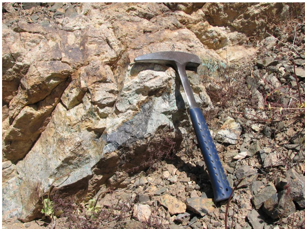
شکل (۶-۳): توف سیلیسی حاوی پیریت اکسید، ملاکیت، الیژست و هماتیت (نمونه 63m1)
