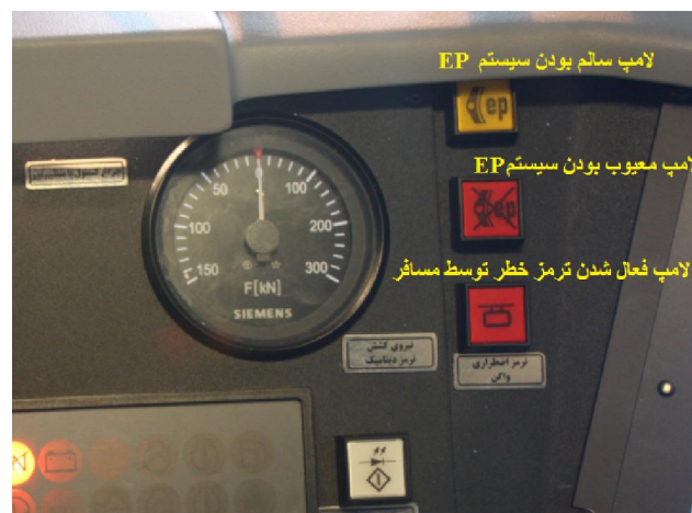
شکل ۴-۱۲۳) لامپ‌های مربوط به سیستم ترمز EP در کنسول لکوموتیوران
