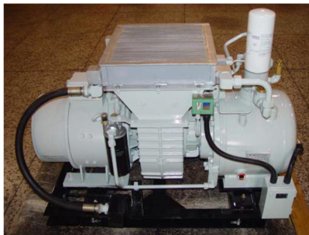
شکل ۳-۳۸) ساختار کمپرسور هوای نوع پیچشی مدل TSA-230D
