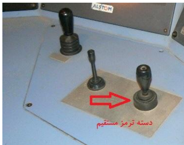
شکل ۴-۱۳) دسته ترمز مستقیم لکوموتیو آلستوم (دسته ترمز در وضعیت ترمزگیری کامل قابلیت قفل شدن دارد)
