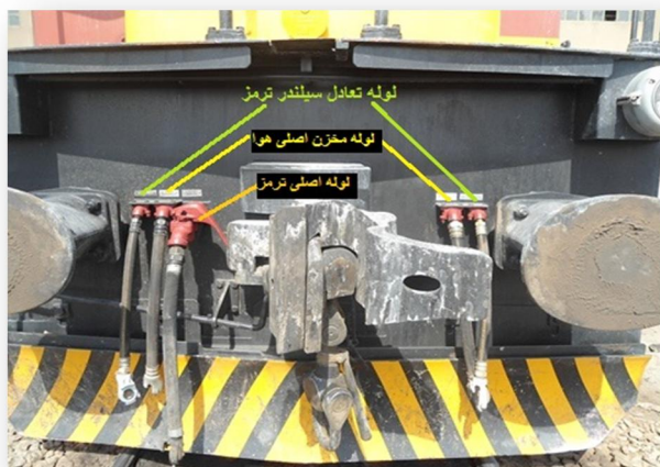
شکل ۴-۹۹) لوله‌های ترمز در لکوموتیوهای GM و GE
