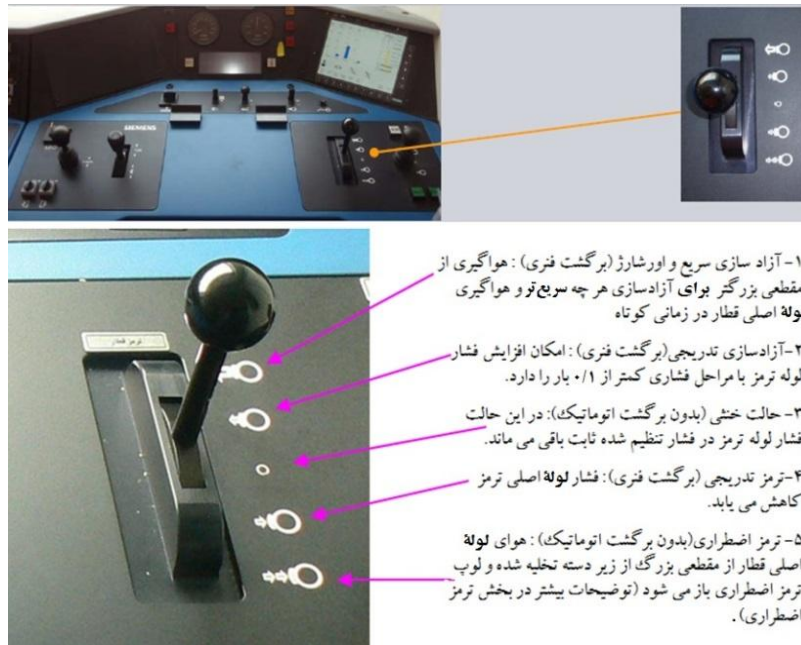
شکل ۴-۳۵) حالت‌های دسته ترمز قطار در لکوموتیو زیمنس
