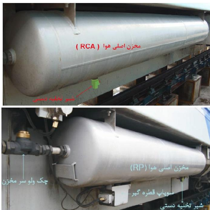
شکل ۳-۱۹) مخزن اصلی هوای فشرده لکوموتیو آلستوم ایران
