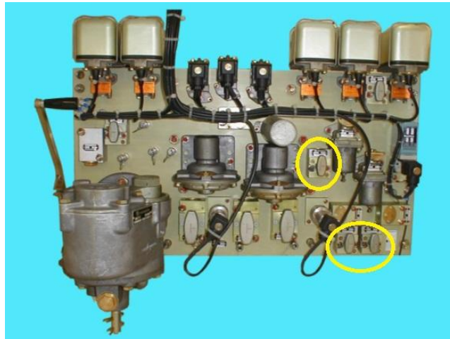
شکل ۴-۱۱۱) قطع شیر ترمز پارک و ترمز مستقیم در هنگام حمل سرد لکوموتیو آلستوم
