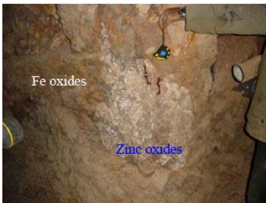
عکس شماره 3-124: نمایی از کانه سازی و آلتراسیون هماتیتی در زون خورد شده ناشی از گسل.
