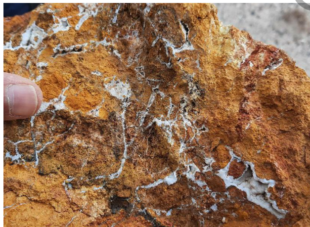
شکل ۴-۱۱- دگرسانی لیمونیتی و کربناته در محل کانی سازی مس در محدوده اکتشافی کوه سرخ
