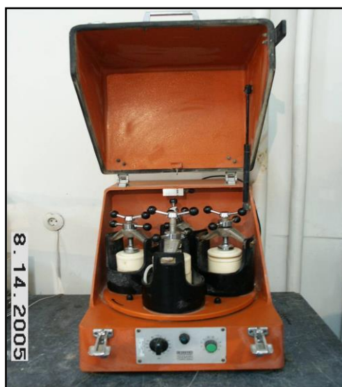
شکل 1-4 دستگاه آسیاب جهت خردایش رسوبات برای آزمایش کلسی متری و ICP
