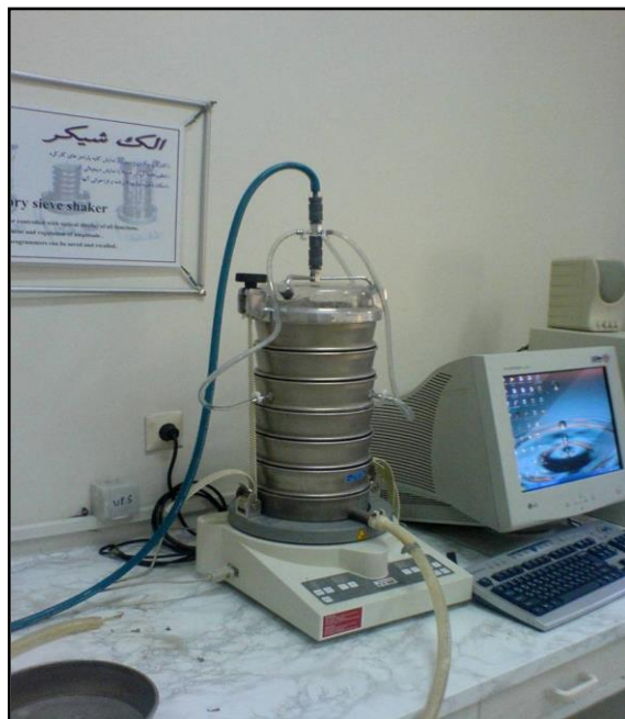
شکل 1-1 دستگاه الک شيكر برای دانه بندی رسوبات به روش مرطوب
