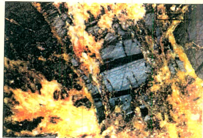
نمونه M4: نمایی از ماکل پلی سنتتیک در استینیت ( Nocols Not Crossed ( × 50 )
