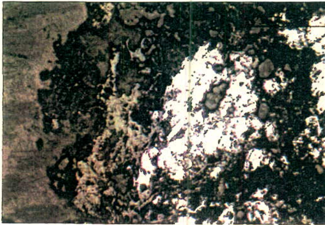
نمونه M7: بلورهای کشیده استینیت که در لابلای دانه های گانگ استقرار یافته اند. ( \times 50 ) Nocols Not Crossed
