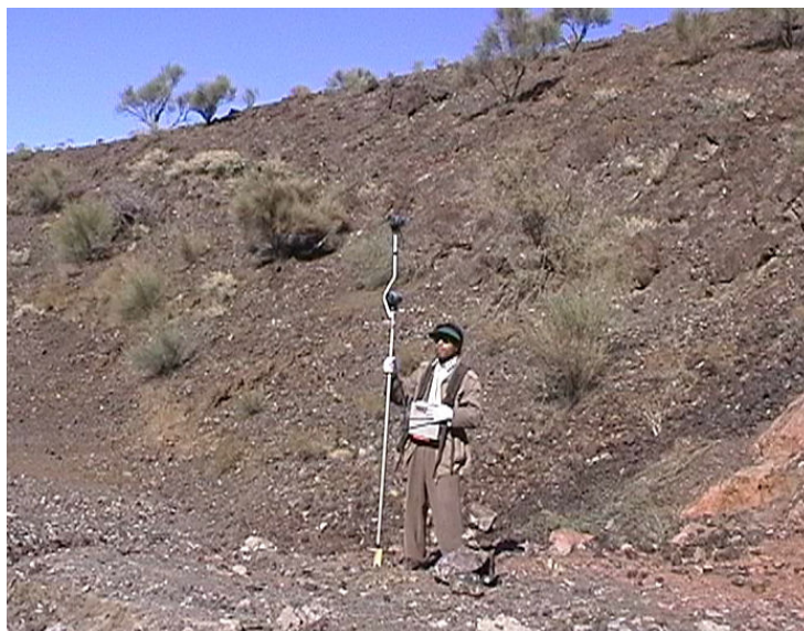
تصویر شماره ۶. عملیات اندازه گیری مغناطیس با استفاده از مغناطیس سنج MP3
