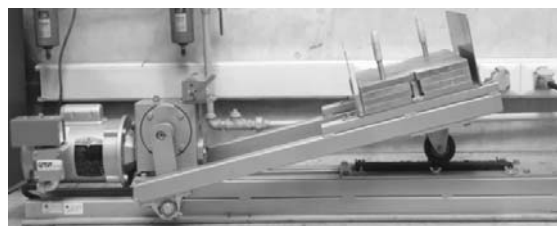
شکل ۵- آزمایش بارگذاری چرخ (جابجایی افقی و قائم)
