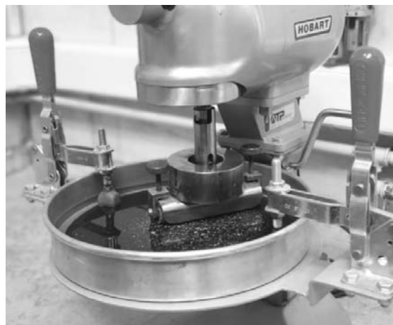
شکل ۳- آزمایش سایش در شرایط مرطوب
