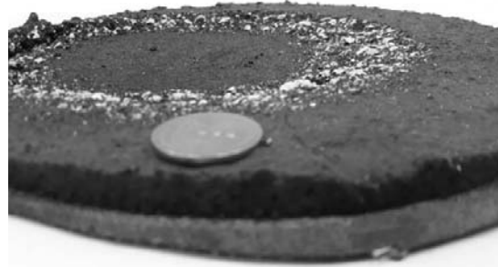
ج- مخلوط میکروسرفیسینگ بعد از انجام آزمایش سایش مرطوب پس از عمل آوری شش روزه شکل ۸- اهمیت سازگاری اجزای مخلوط میکروسرفیسینگ در آزمایش سایش شش روزه
