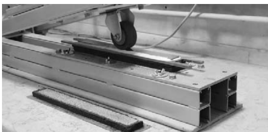
شکل ۴- آزمایش بارگذاری چرخ (مقدار ماسه چسبیده)
