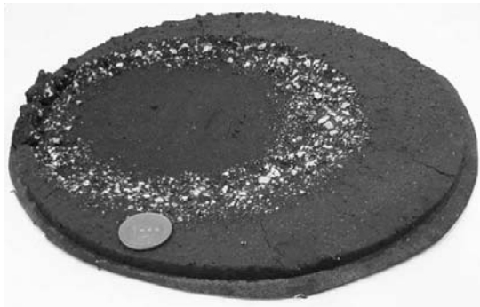
ج- مخلوط میکروسرفیسینگ بعد از انجام آزمایش سایش مرطوب پس از عمل آوری شش روزه شکل ۸- اهمیت سازگاری اجزای مخلوط میکروسرفیسینگ در آزمایش سایش شش روزه
