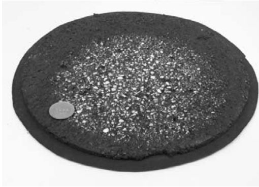
ب- مخلوط میکروسرفیسینگ بعد از انجام آزمایش سایش مرطوب پس از عمل آوری یک ساعته
