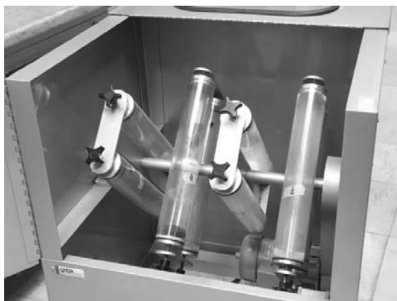
شکل ۶- آزمایش رده‌بندی (سازگاری)
