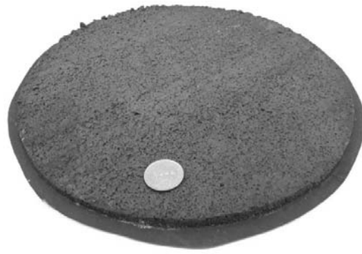
الف- مخلوط میکروسرفیسینگ قبل از انجام آزمایش سایش مرطوب
