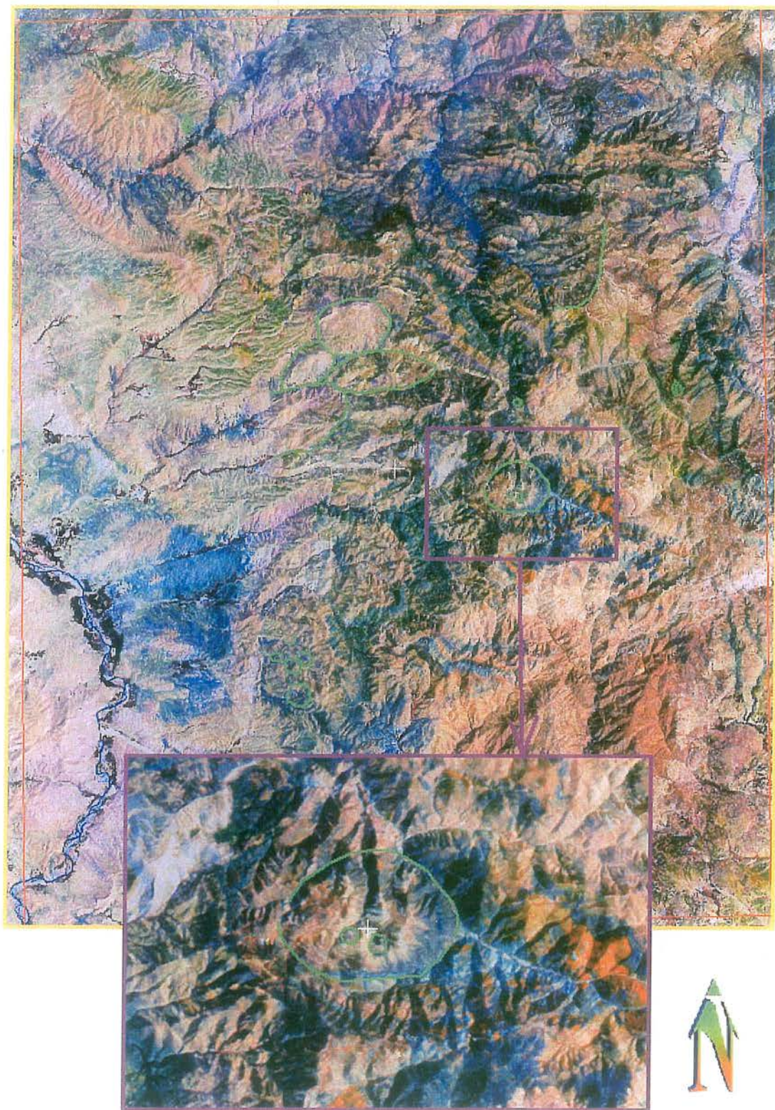
تصویر شماره ۲۲ تصویر با ترکیب بانندی ۵،۳،۱ در محیط RGB جهت تشخیص ساخت های دایره ای شکل .
