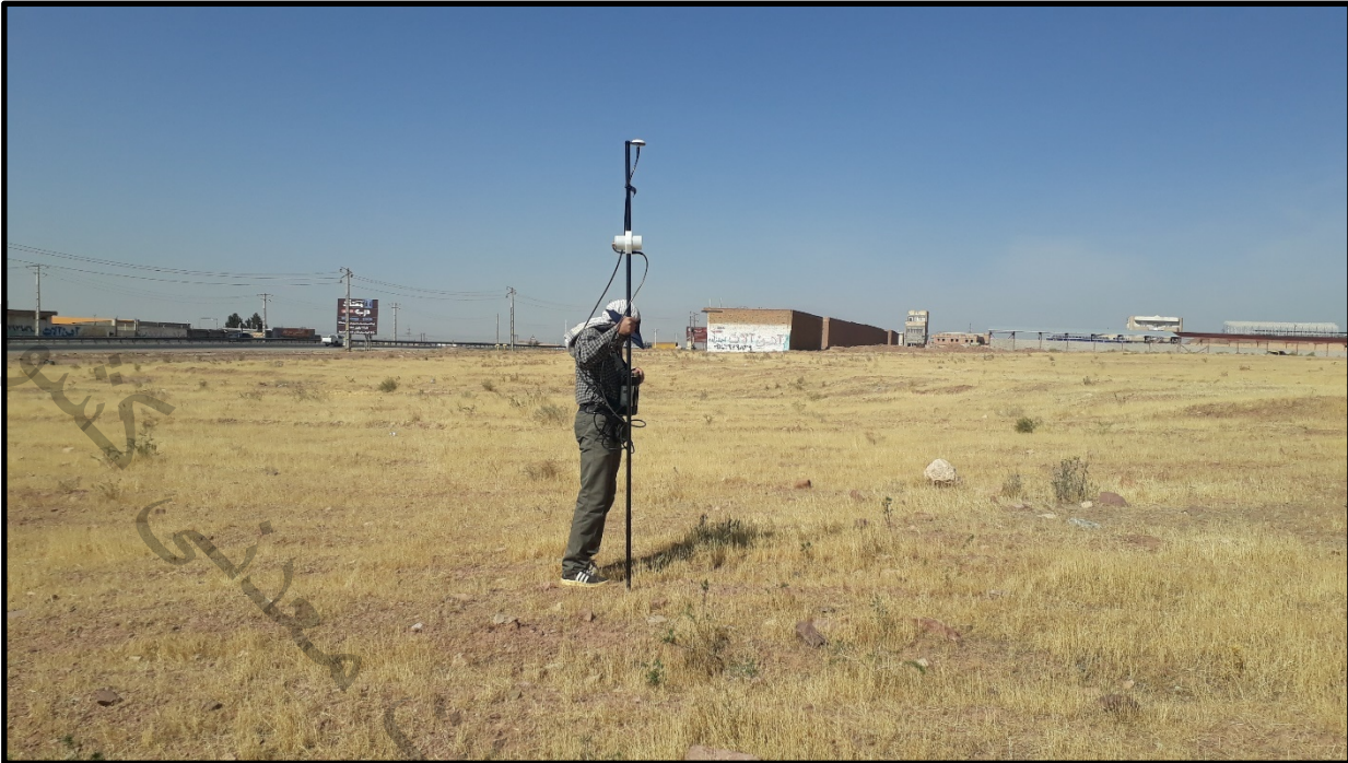
شکل ۳-۷: برداشت داده های مغناطیس سنجی در محدوده پروفیل های ۱۸ و ۱۹ مقاومت ویژه
