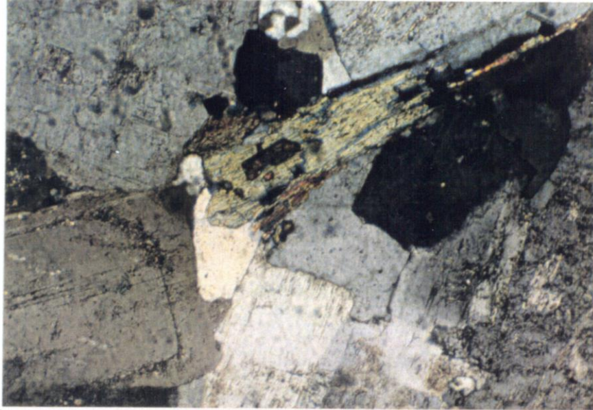
تصویر شماره ۱۱ : کانیهای فرعی شامل بلورهای لوزی شکل اسفن، دانه‌های آپاتیت و همچنین کانه‌های تیره رنگ که از دگرسانی کانیهای سیلیکاته مافیک نظیر آمفیبول سبز بوجود آمده‌اند.
