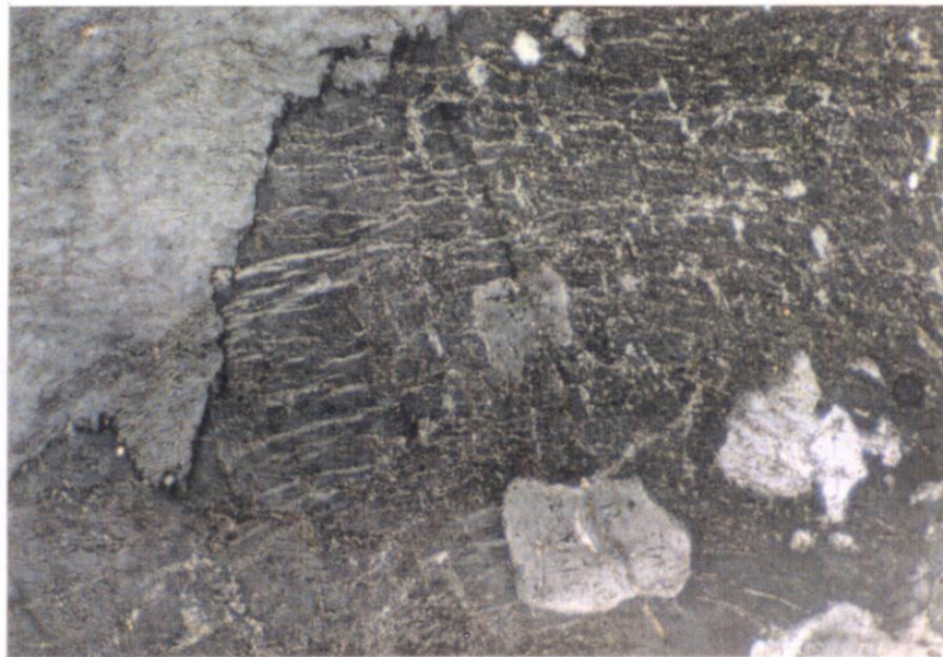
تصویر شماره ۱۲: نوعی فلدسپات برتیتی را نشان می‌دهد که در آن فاز میزبان فلدسپات پتاسیک و فاز واخورده میزبان فلدسپات پتاسیک و فاز واخورده نواری بعنوان فاز مهمان از آلبیت در آن قرار گرفته است. هر دو این کانیها در اصل بصورت محلول جامد بوده‌اند (6.3 × 12.5X).
