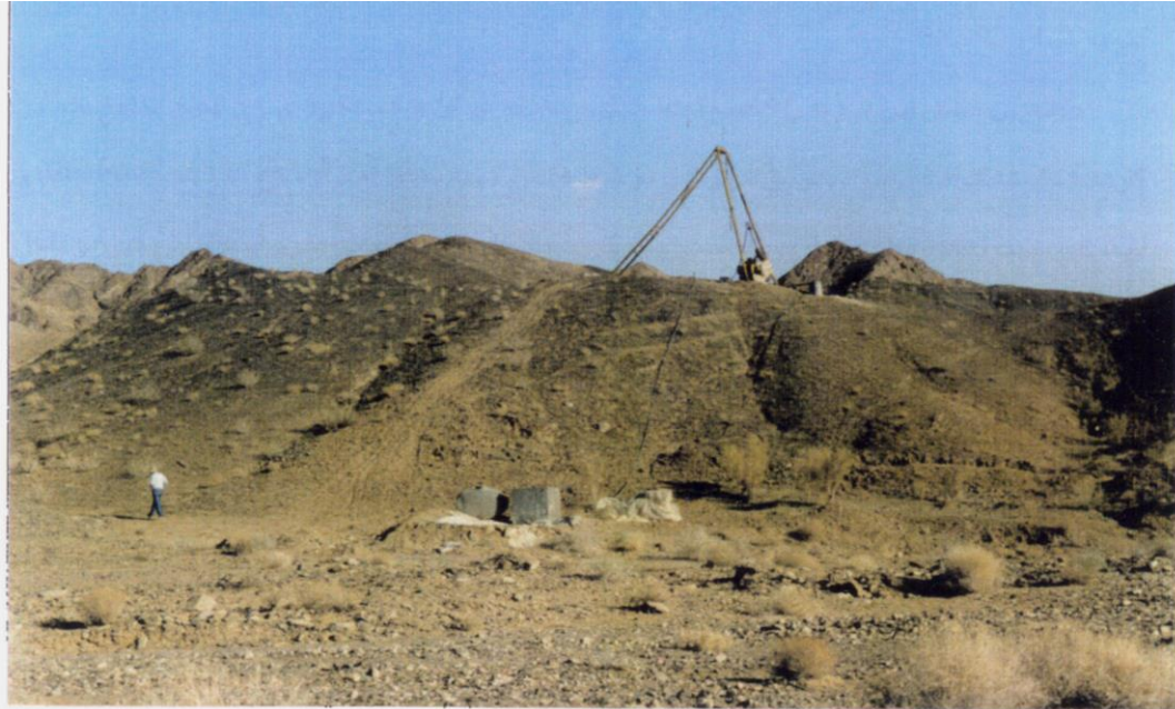
تصویر شماره ۵۲: دستکاه حفاری بر روی تپه مستقر گردیده و به سوی رگه شماره IIVK1 حفاری می‌نماید.
