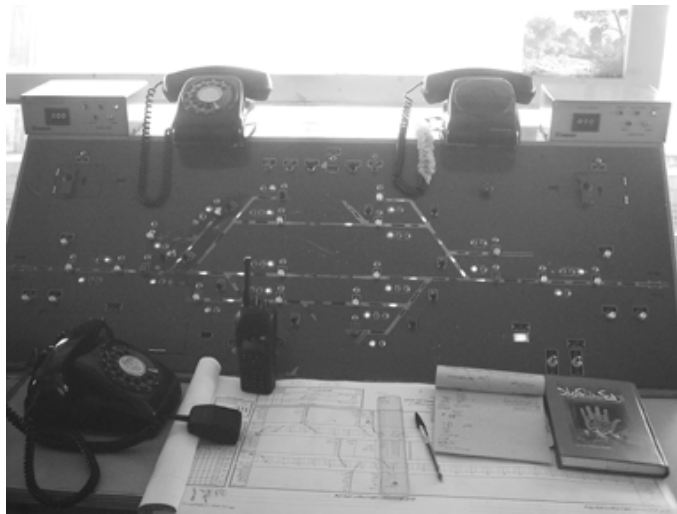
شکل ۴-۵ پانل کنترل دستگاه اینترلاکینگ رله ای
