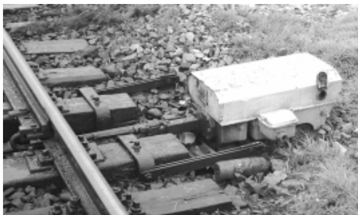
شکل ۵-۳۲ ماشین سوزن S700
