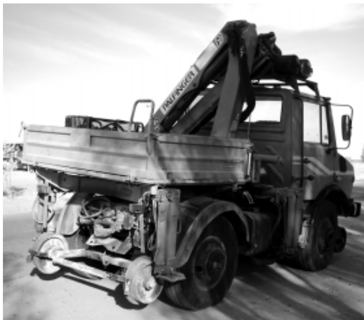
شکل ۴-۳۵ ماشین عملیات کابل کشی
