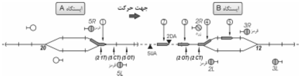
شکل ۳-۷ عملیات دستگاه بلاک نیمه خودکار
