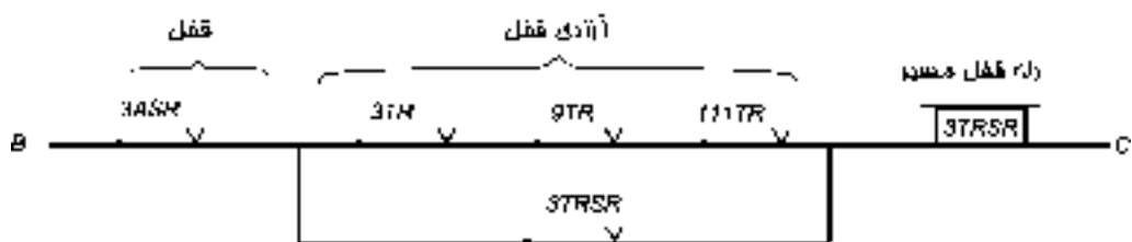
شکل ۶-۱۰ مدار رله قفل مسیر
