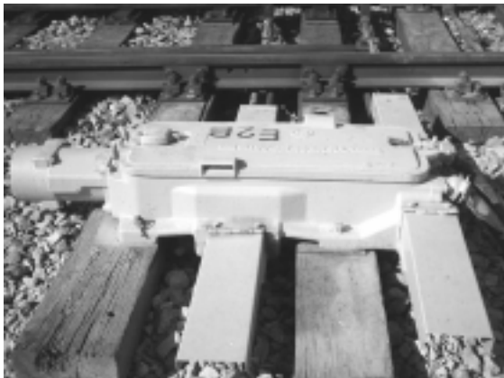
شکل ۵-۱۶ ماشین سوزن الکتریکی
