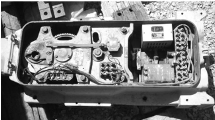
شکل ۵-۱۹ ماشین سوزن و رله کنترل مدار سوزن
