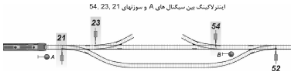
شکل ۶-۴ الف) قفل بین سیگنال A و سوزن های ۲۱, ۲۳ و ۵۴
