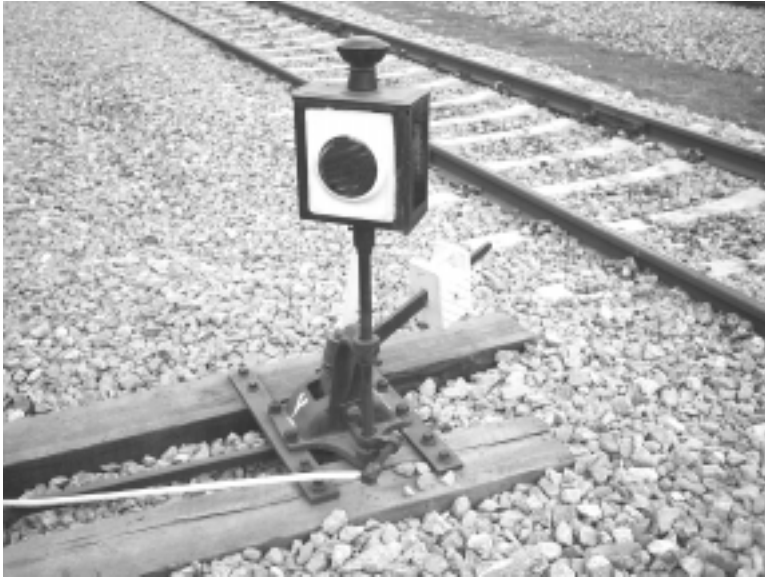
شکل ۵-۱۰ اهرم سوزن با شاخص
