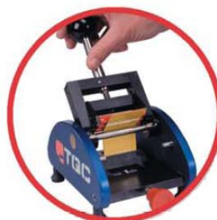
شکل ۷-۵. فرآیند اجرای آزمون خمش مندرل رنگ و پوشش
