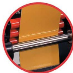
شکل ۷-۵. فرآیند اجرای آزمون خمش مندرل رنگ و پوشش
