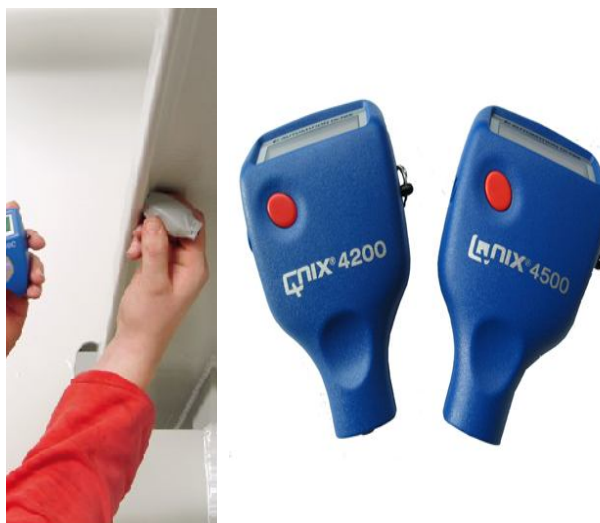
شکل ۷-۳. نمونه‌ای از دستگاه و فرایند اجرای آزمون اندازه‌گیری ضخامت فیلم رنگ
