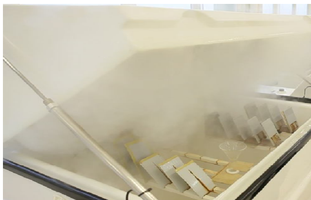
شکل ۲-۷ ج. نمونه ای از دستگاه و فرآیند اجرای آزمون سالت اسپری
