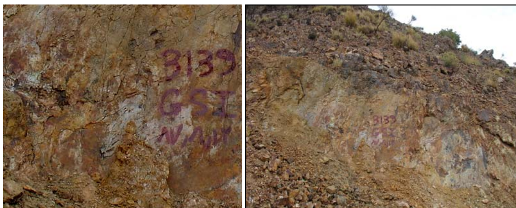
(شکل-۴۴) رگه های مس دار با کانی سازی مالاکیت، آزوریت و کالکوپیریت، پیریت شمال روستای زویه در مسیر مدین
