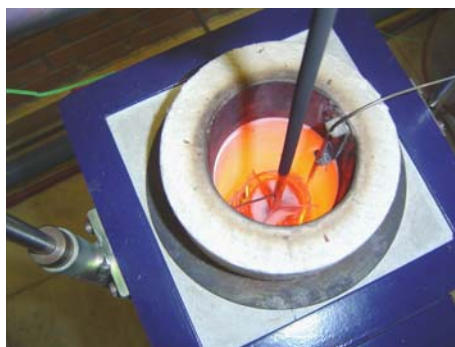
شکل ۲-۲ تصویر از آزمون قابلیت سوختن مواد (آزمایشگاه آتش مرکز تحقیقات راه، مسکن و شهرسازی)
