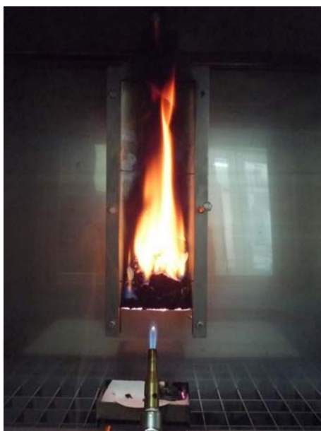
شکل ۱-۲ تصویری از آزمون قابلیت آفرزش در برخورد مستقیم با یک منبع تک شعله (آزمایشگاه آتش مرکز تحقیقات راه، مسکن و شهرسازی)
