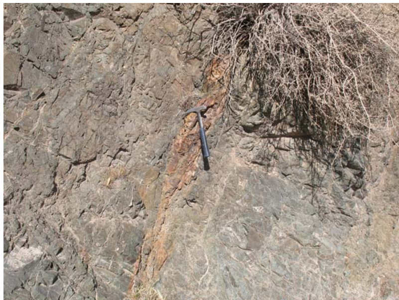
شکل ۳-۱۶: کانی‌سازی مس و اکسیدهای آهن در رگه سیلیسی با سنگ میزبان آندزیت‌های واحد E^{ad}
