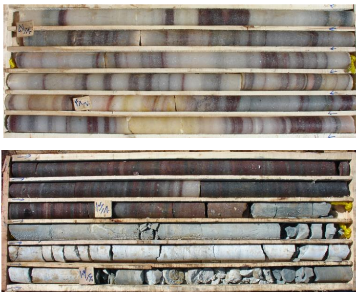
شکل 3-10- بالا: نمک های الوان در روانه نمکی کوه نمک پل. پایین: کنتاکت نمک های سیاه رنگ کمر پایین روانه نمکی با مارن های سبز رنگ سنگ بستر (سازند گچساران) در عمق 107/2 متر.
