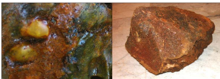
شکل 3-15- بافت داخلی ذخیره پتاس شامل فنوکریست هایی است که در راستای محور چین ها قرار گرفته اند و خمیره دانه ریز جهت یافتگی دارد. طول بلورهای سیلویت 3 سانتیمتر است.
