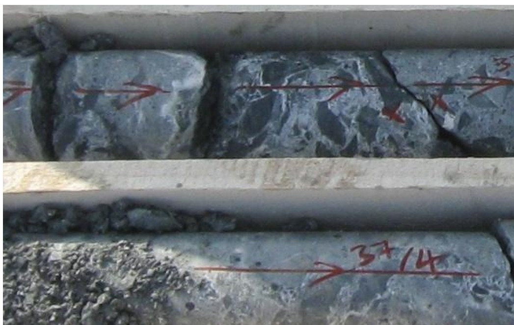
شکل ۷-۴- تصویری از بافت برشی در عمق ۸۰ متری گمانه DH6
