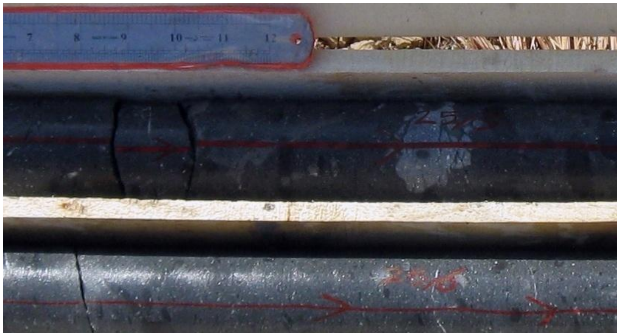
شکل ۷-۳- تصویری از بافت برشی در عمق ۴۴ متری گمانه DH3
