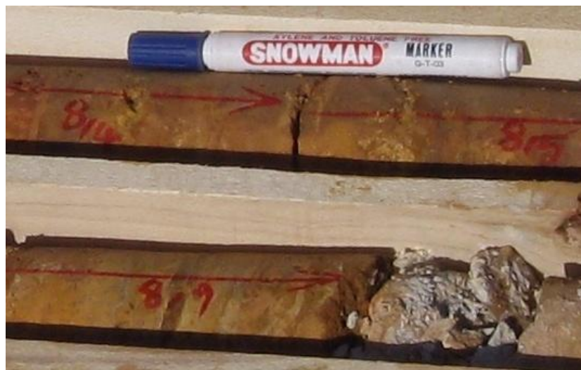
شکل ۷-۵- تصویر از زون اکسیدان در گمانه DH7، عمق ۱۰,۵ متر
