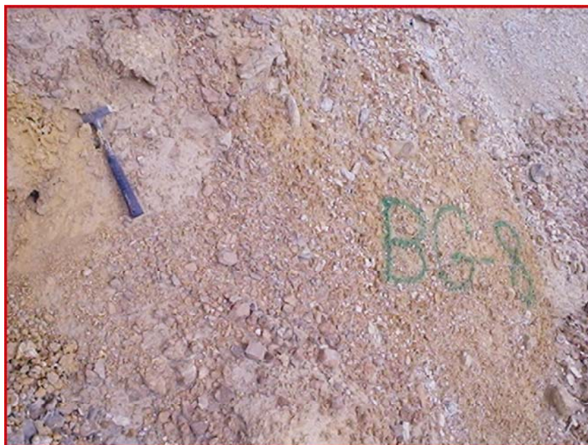
تصویر ۴-۱- لایه‌های ماسه‌سنگی درون شیل‌ها با مقادیر غیرمتعارف روی و تا حدودی سرب
