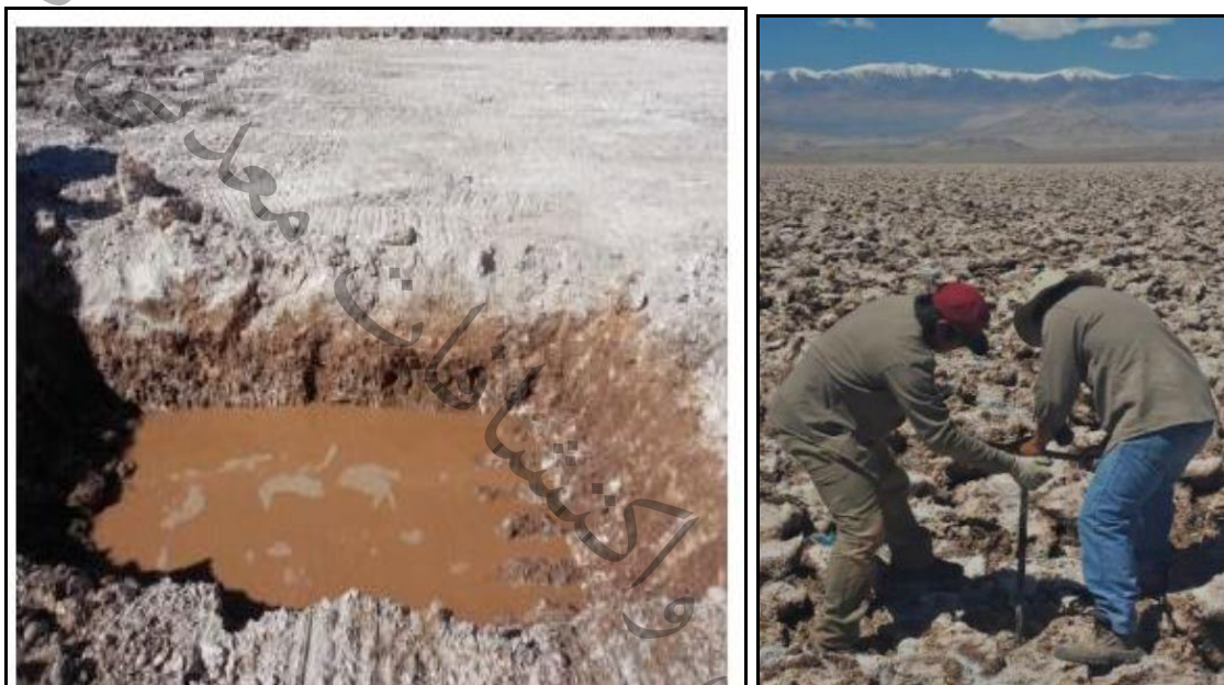
شکل ۴۳- برداشت نمونه با اوگر و کندن سطح پلایا تا رسیدن به شورابه، جهت برداشت شورابه
