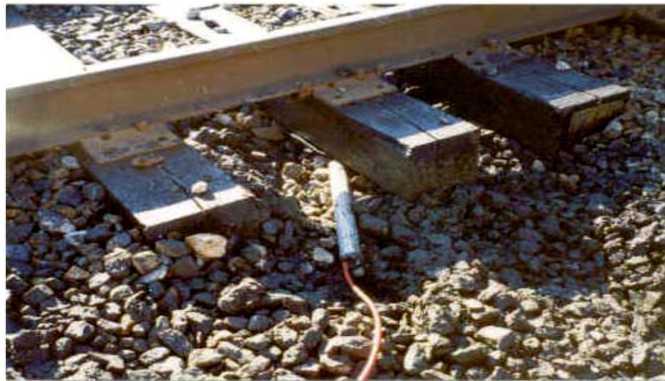
شکل ۵-۸) تصویر تست اندازه‌گیری فشار در داخل خط
