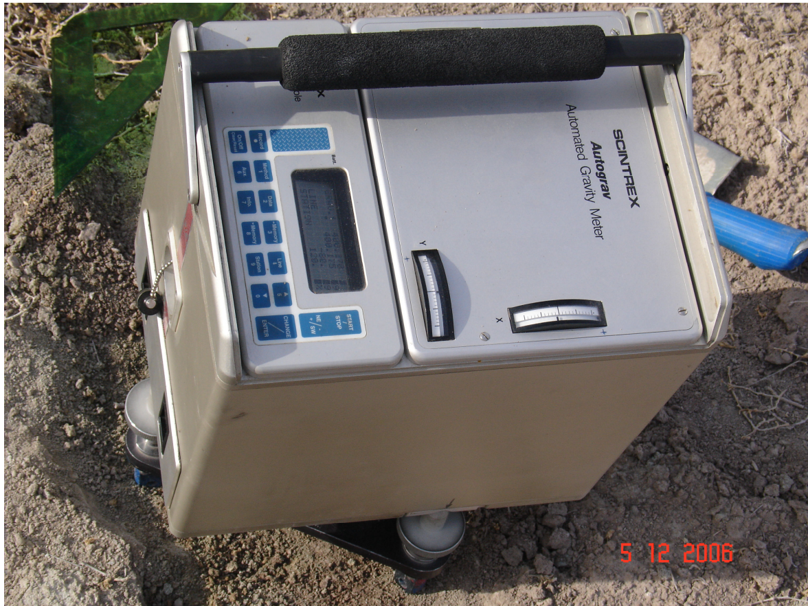
تصویر شماره ۱: نمایی از دستگاه گراویمتر مدل CG3 بر روی سه پایه کوتاه
