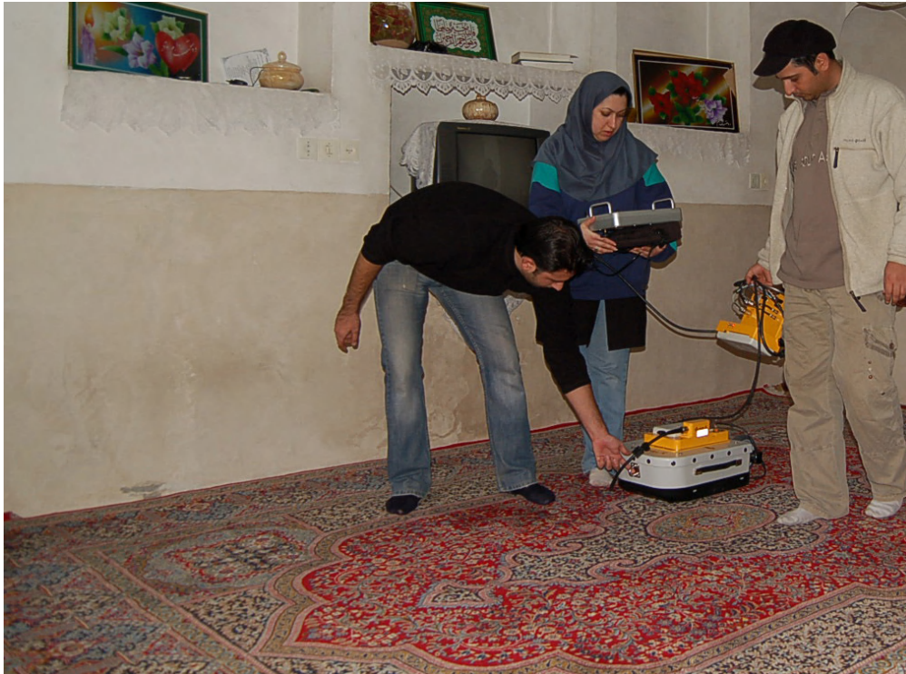
تصویر شماره ۱۰- برداشت شبکه با آنتن ۵۰۰ مگا هرتز پوشش دار در شبکه شماره یک
