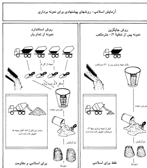
شکل ۹-۱ روش استاندارد و جایگزین برای نمونه برداری و آزمایش اسلامپ بتن آماده
