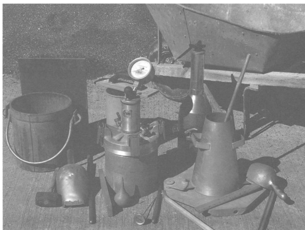
شکل ۱۰-۲ تجهیزات آزمون بتن در محل کارگاه
