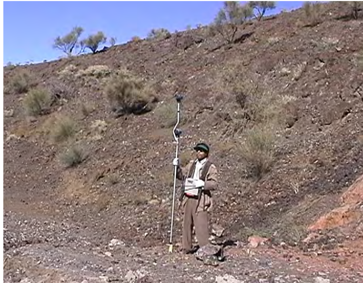
تصویر شماره ۵ - عملیات اندازه گیری مغناطیس با استفاده از مغناطیس سنج MP3
