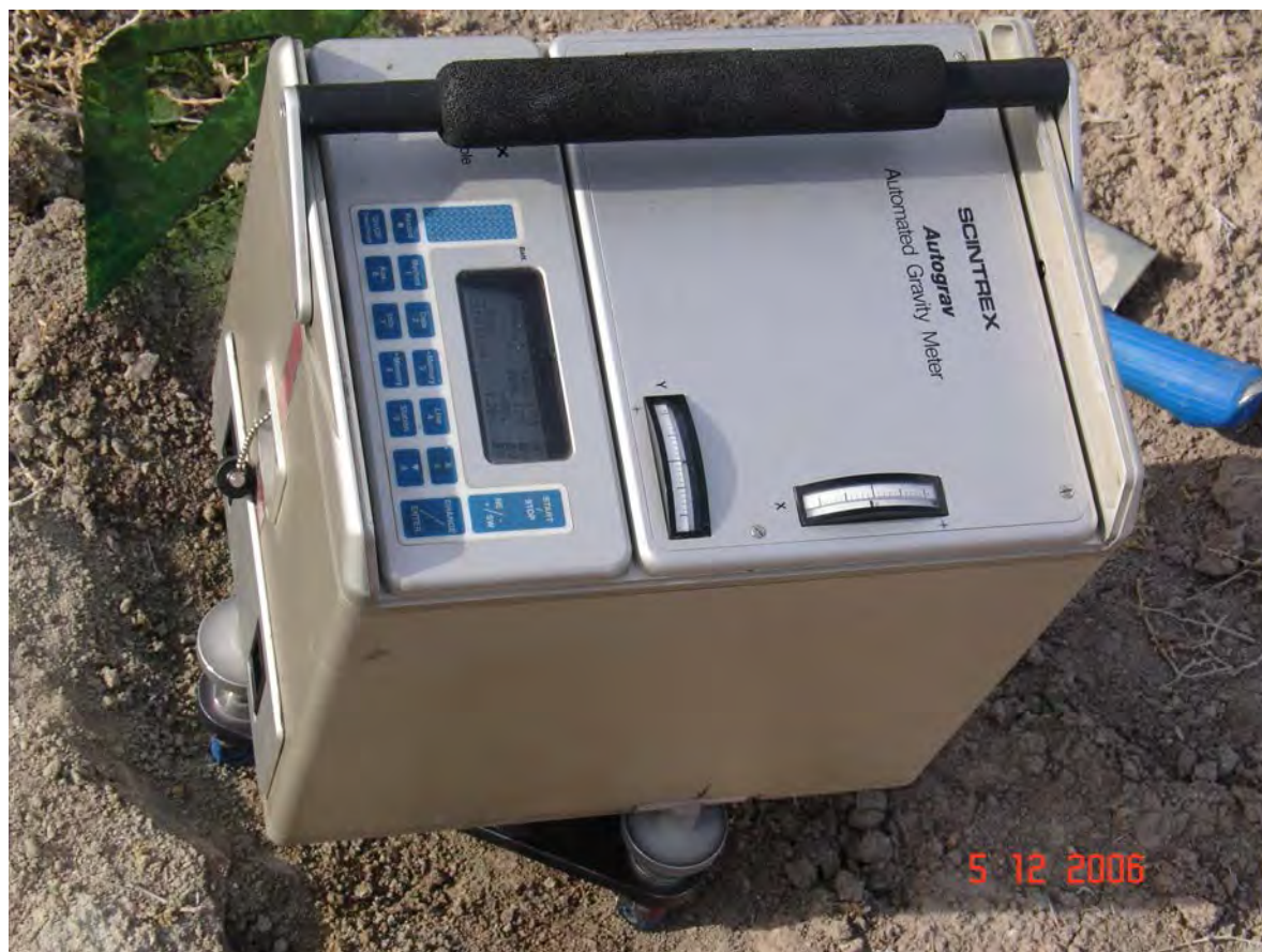
تصویر شماره ۳. نمایی از دستگاه گرانی سنج مدل CG3 بر روی سه پایه کوتاه
