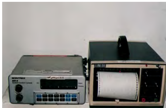
تصویر شماره ۴- دستگاه مغناطیس سنج MP3
