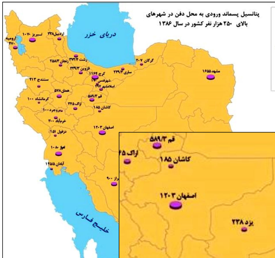
شکل ۱-۲۲ پتانسیل پسماند ورودی به محل دفن زباله (برحسب تن در روز) (وزارت نیرو-سازمان انرژی‌های نو)
