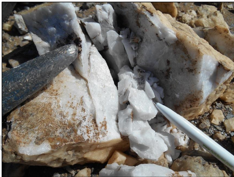
شکل ۴-۱۰- نمای نزدیک از رگه‌های کوارتز که نشان از خلوص بالایی سیلیس دارد و فاقد اکسید آهن و سایر عناصر پایه می‌باشد
