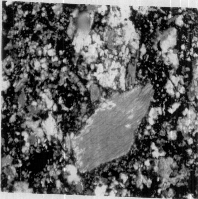
تصویر شماره ۱۱. در این تصویر کانی‌های هورنبلند، پیروکسن، کواتز و اسفن مشاهده می‌گردد. بزرگنمایی 63X-نور پلاریزه.
