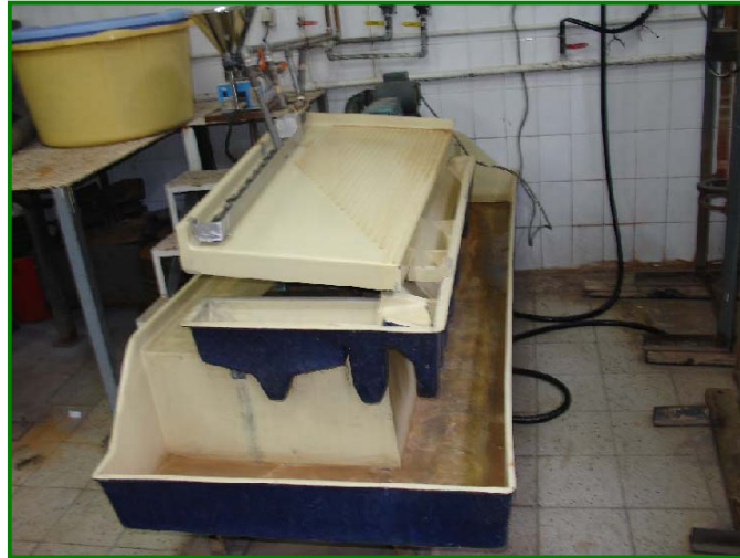
شکل ۶-۲: دستگاه میز لرزان مورد استفاده در آزمایشات- آزمایشگاه کانه آرایی سازمان زمین شناسی
