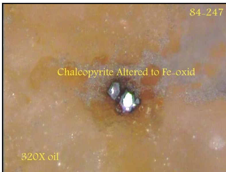
عکس ۲-۴ - تجزیه کالکوپیریت به اکسیدهای آهن
