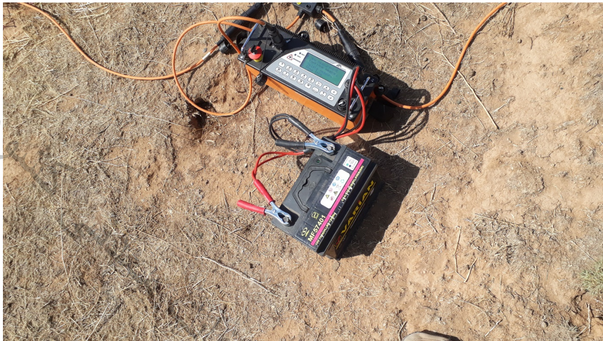
شکل ۳-۵: دستگاه ARES و تصویری از عملیات برداشت
