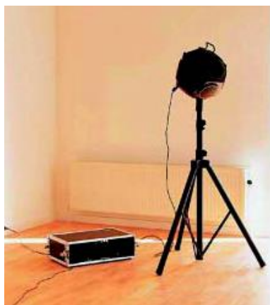
شکل ۲-۲۸ منبع صدای تمام جهتی مدل ۴۲۹۶ به همراه تقویت کننده توان (Amplifier Type 2716C Power)
