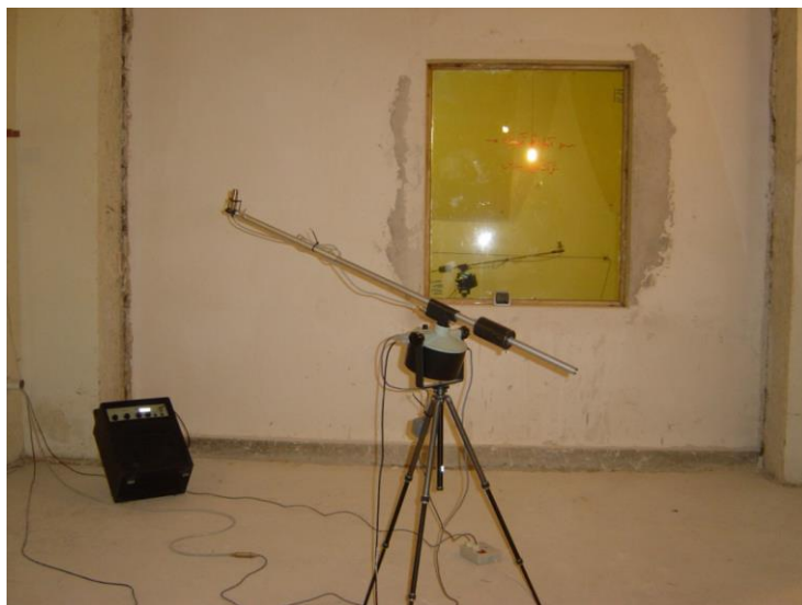
شکل ۲-۳۸ اندازه گیری تراز صدا در دو اتاق برای محاسبه صدابندی شیشه
