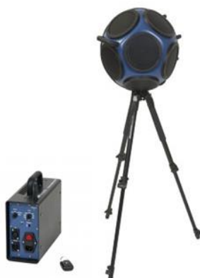
شکل ۲-۲۷ بلندگوی دوازده وجهی مدل Nor276 همراه با تقویت کننده توان مدل Nor280
