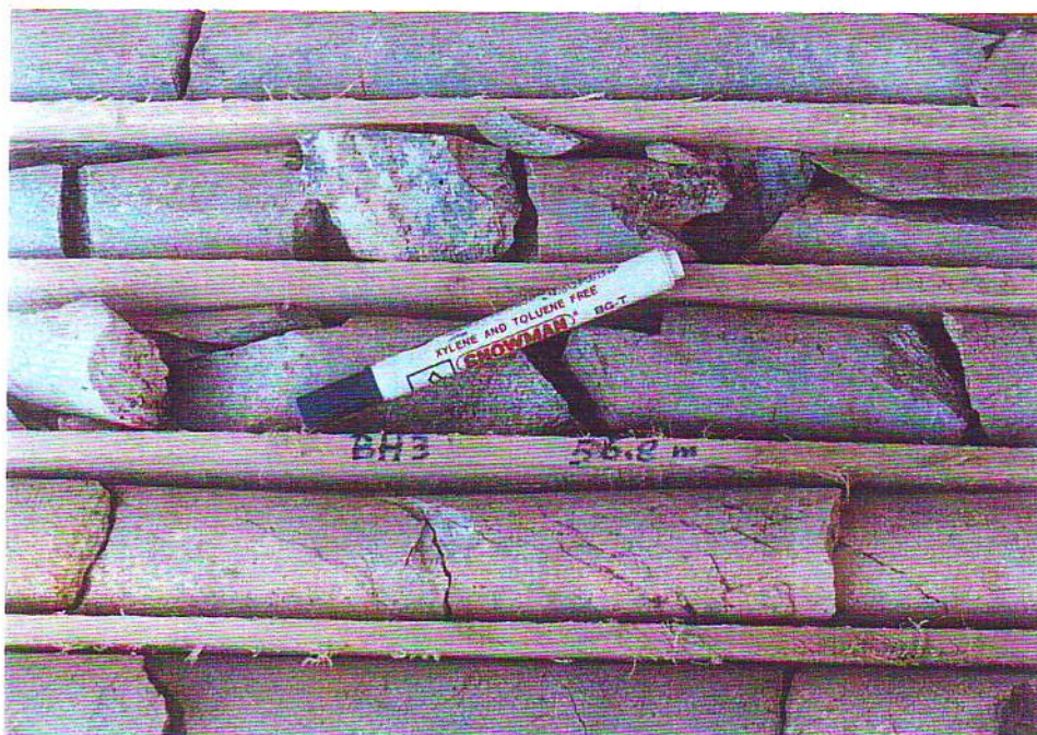
تصویر شماره ۱۰- نمایی از رگچه آزوریت در عمق ۵۷/۸۰ متر و نیز رگچه‌های اکسید شده دیگر.
