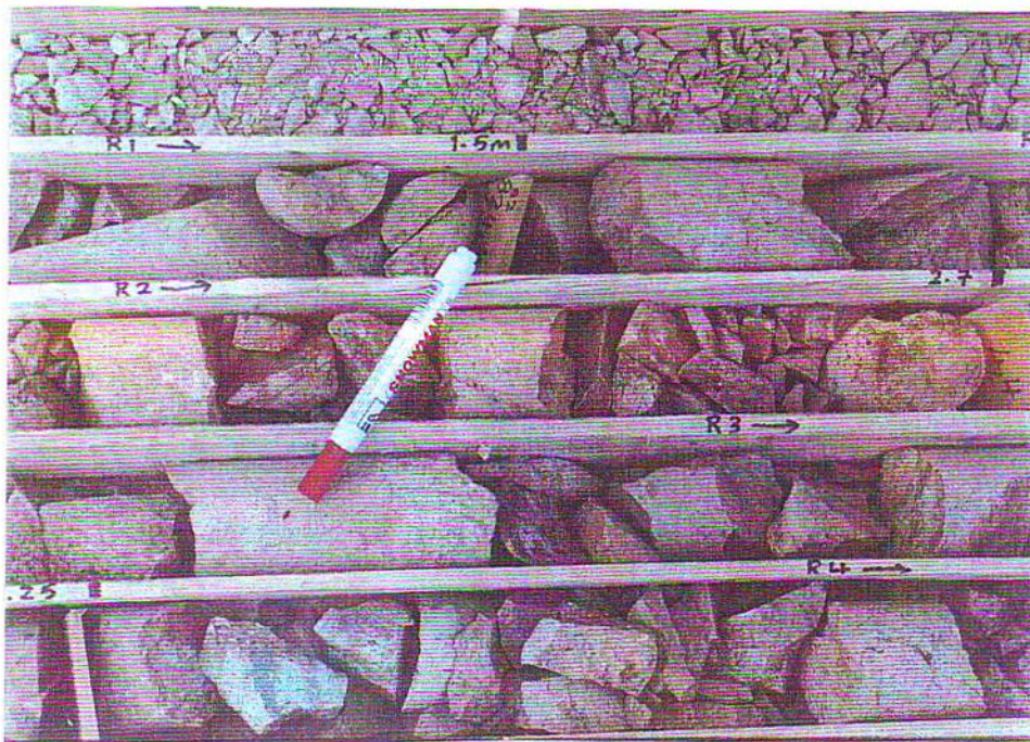
تصویر شماره 8- نمایی از خردشدگی سنگها و رگچه‌های مالاکیت - آزوریت و اکسیدشدن سنگها در ابتدای گمانه BH3
