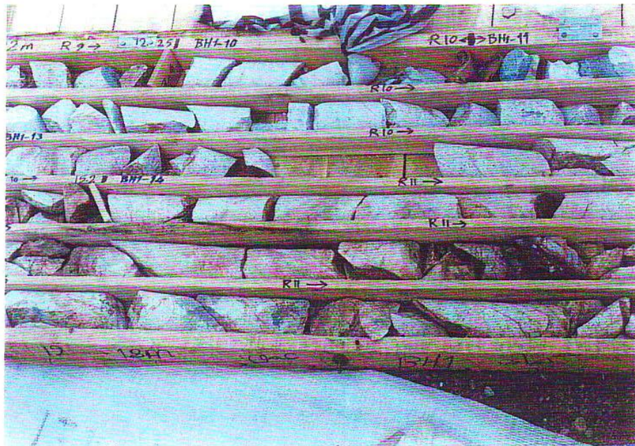
تصویر شماره ۱- نمایی از خرد شدگی در سنگهای مونزوگرانیت تا کوارتز مونزونیت ریز بلور سیلیسی شده همراه با رگچه های مالاکیت و آزوریت و نیز سنگهای لیمنیتی و هماتیتی شده. عمق ۱۲ تا ۱۸ متری گمانه BH1
