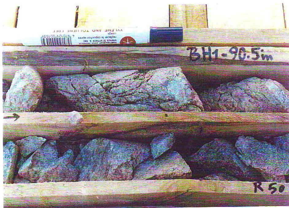
تصویر شماره ۴- نمایی از سنگهای برشی شده و پرعیار از پیریت و تا حدی کالکوپیریت به صورت ریز بلورهای پراکنده. از عمق ۹۰/۵۰ متر گمانه BH1
