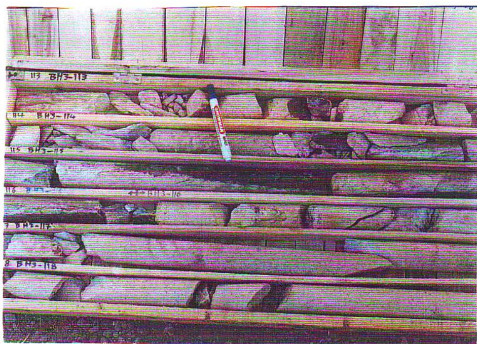
تصویر شماره ۱۱- تأثیر اکسیداسیون بر رگچه‌ها به دلیل باز بودن درزه‌ها در عمق ۱۱۸/۰ - ۱۱۳/۰ در گمانه BH3
