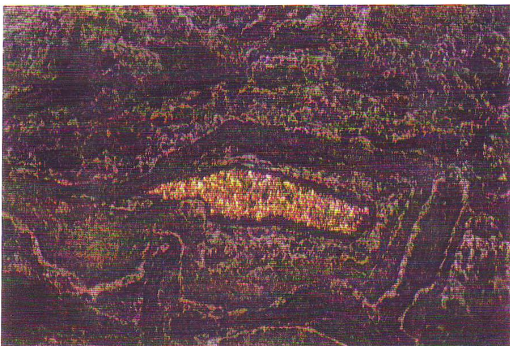
تصاویر شماره ۲ و ۱ - نمایی از جانشینی دانه‌های پیریت با بافت غربالی توسط نوارهای متناوب و ظریف گوتیت - لپیدوکروسیت طی تأثیر هوازگی X(20 × 12.5) PPL
