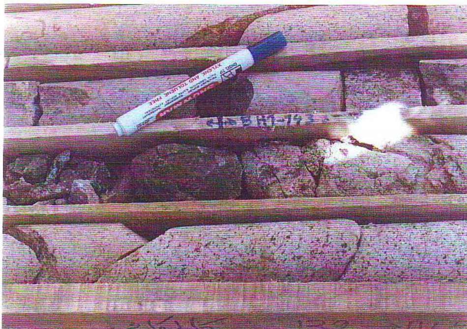
تصویر شماره 6- نمایی از سنگهای برشی و تا حدی کائولینی و پرعیار از کالکوپیریت پراکنده در نمونه BH1-143 و رگچه مگنتیتی کنار آن در گمانه BH1
