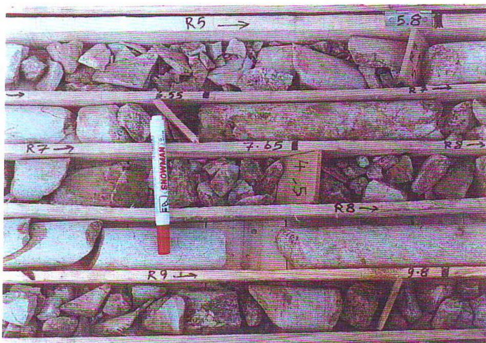
تصویر شماره 9- نمایی از سنگهای خردشده و لیمونیتی گمانه BH3 از عمق 5/40 تا 9/80 متر از عمق 29/0 متر از تعداد رگچه‌های کربنات و در نتیجه، کربناتی شدن سنگ کاسته می‌شود.
