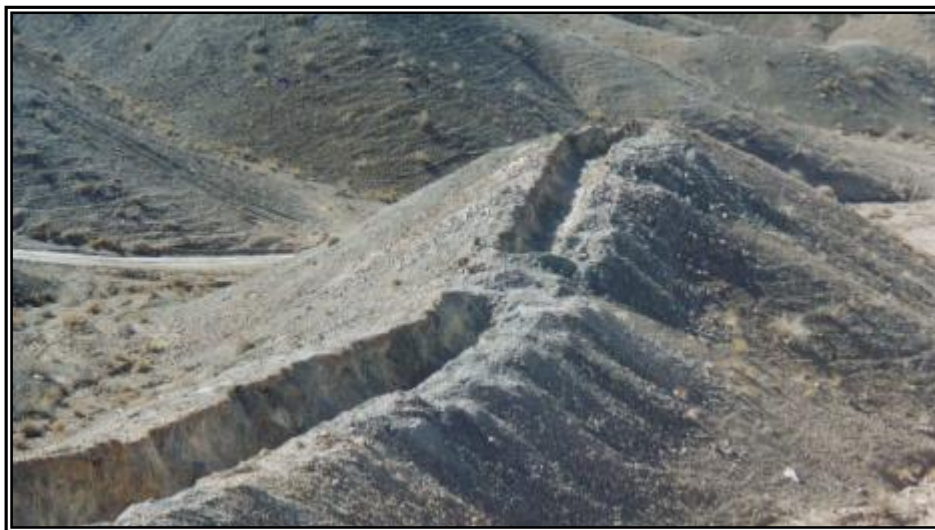
تصویر 12: ترائشه های اکتشافی بر روی ریولیت های دگرسان شده، محدوده اکتشافی عناصر رادیواکتیو زیریگان.
